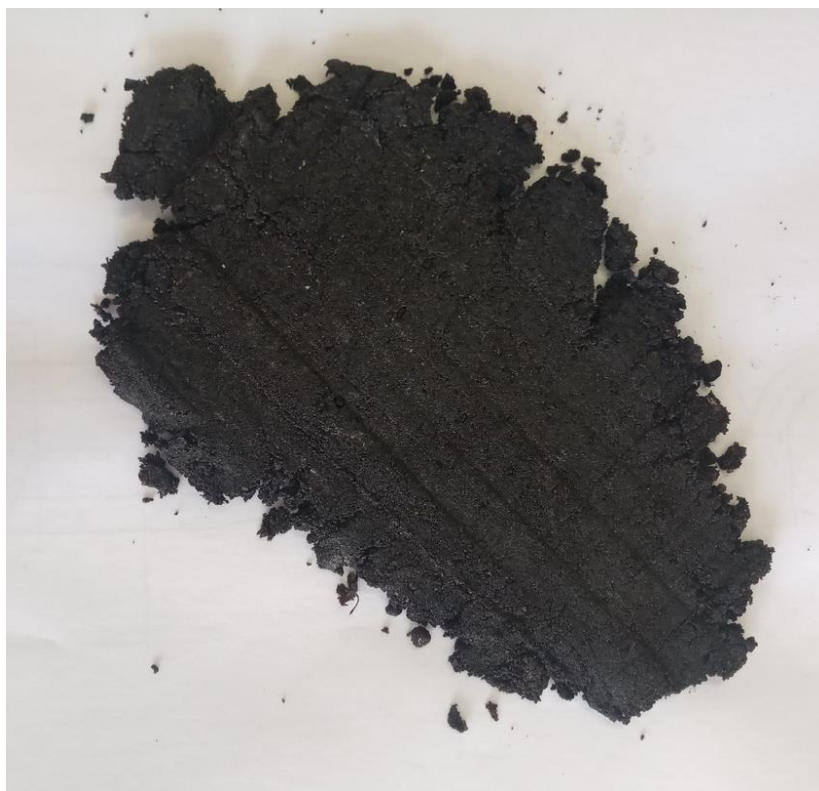
Рисунок 18 – Внешний вид полимер-песчаного композита, полученного из агломерата из загрязненного полиэтилена
