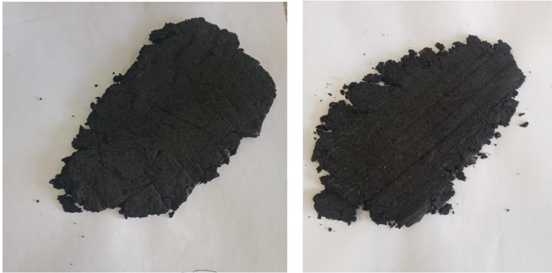
Рисунок 19 – Образцы полимер-песчаного композита для визуального сравнения (слева полимер-песчаный композит, полученный из незагрязненного полиэтилена, а справа полимер-песчаный композит, полученный из загрязненного полиэтилена)
