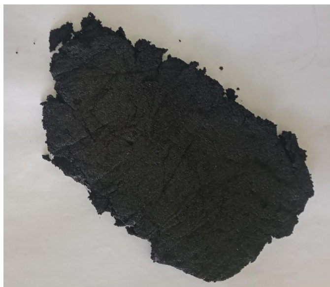
Рисунок 16 – Внешний вид полимер-песчаного композита, полученного из агломерата из незагрязненного полиэтилена
