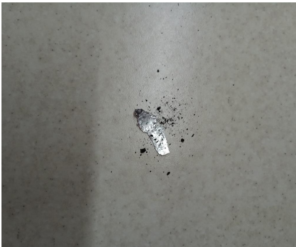
Рисунок 17 – Металлическое включение из агломерата из загрязненного полиэтилена
