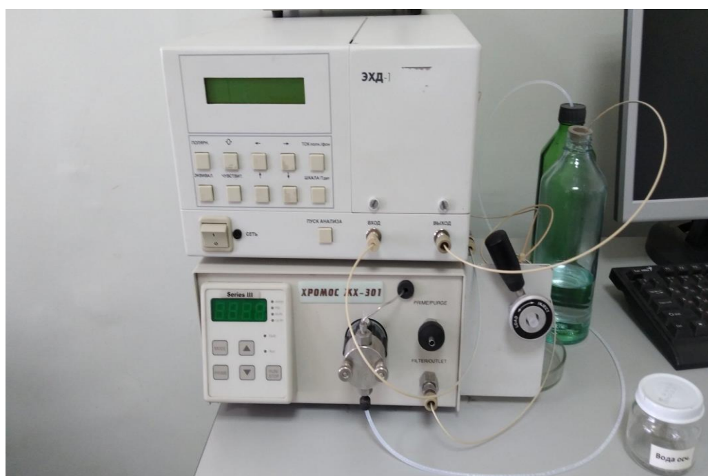
Рисунок А.12 – прибор «Хромос» (для определения фенола)
