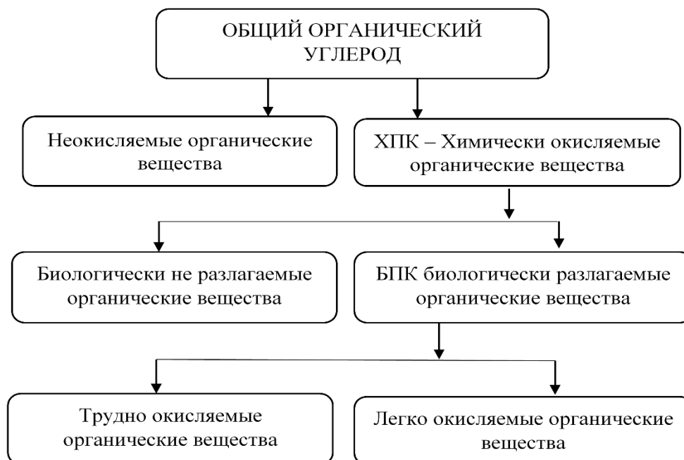
Рисунок 3 – Классификация органических веществ, содержащихся в сточных водах по их способности к биоокислению
