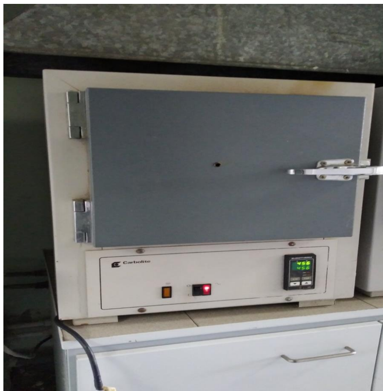
Рисунок А.9 – муфельная печь (для определения сульфатов)
