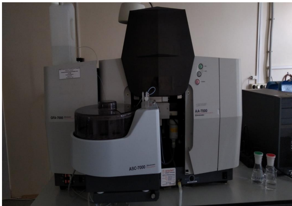
Рисунок А.11 – Атомный спектрофотометр «Шумадзу АА 700» (для определения цинка, свинца, кадмия, мышьяка, никеля, меди)
