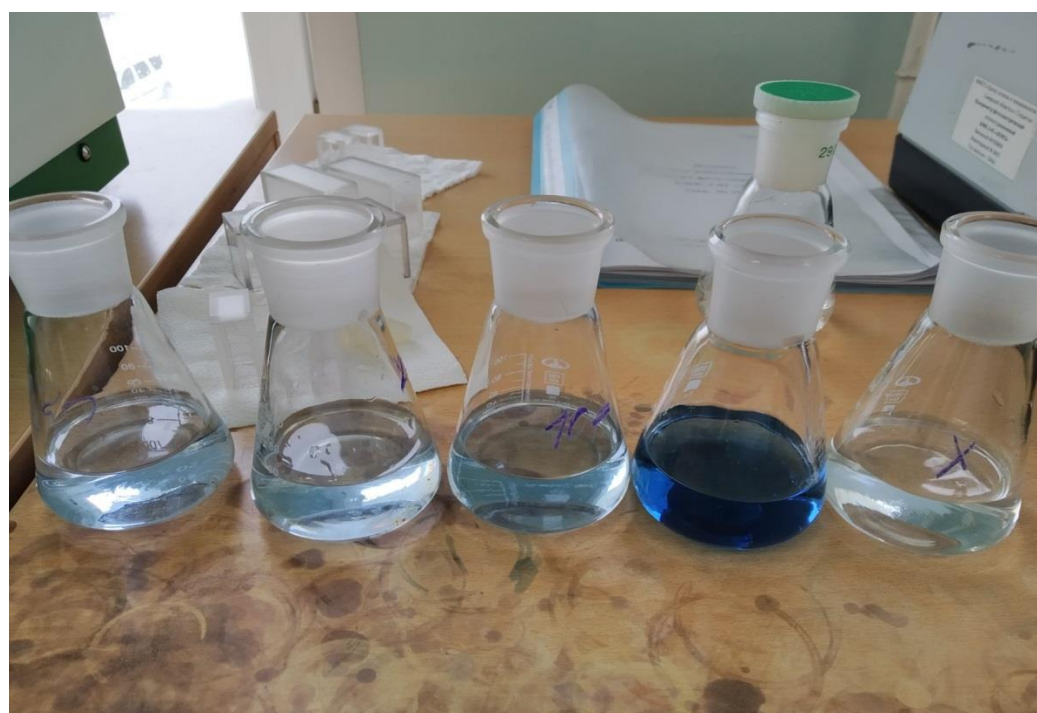
Рисунок А.3 – КХА сточных вод на содержание фосфатов
