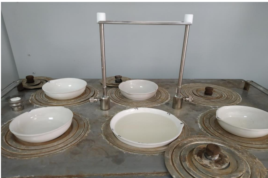
Рисунок А.4 – Определение содержания сухих веществ в пробе сточных вод
