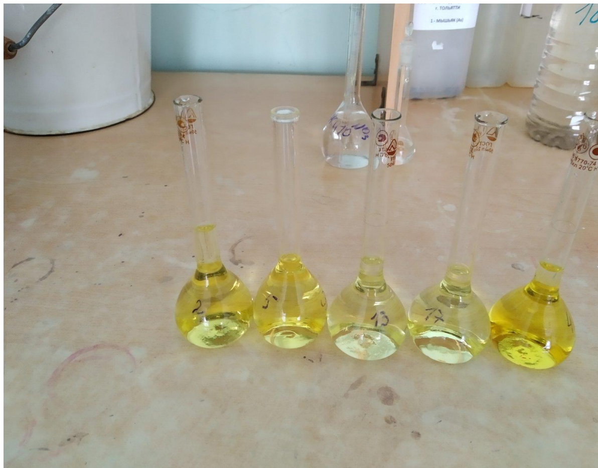
Рисунок А.1 – Количественный химический анализ (КХА) сточных вод на содержание нитратов
