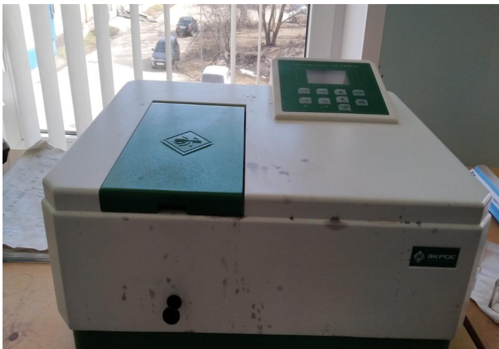
Рисунок А.7 – Спектрофотометр (применяется при определении железа, аммиака, нитратов, фосфатов, хлоридов)
