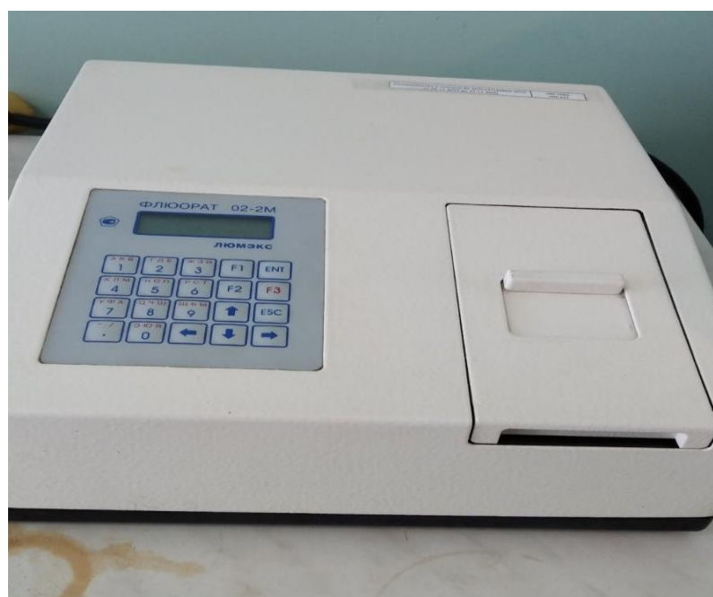
Рисунок А.10 – «Флюорат 02 – 2М» (прибор для определения АПАВ, ХПК)
