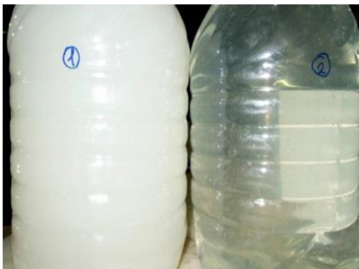
Рисунок 15 - Фотография проб исходной сточной воды (слева) и после реагентной очистки (справа)
