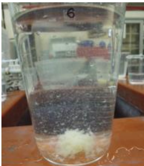
Рисунок 7 - Исходный сток после обработки коагулянтом Superfloc C 595(70 мг/л) и флокулянтom № 68528 (1 мг/л)
