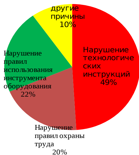
Рисунок 6 – Статистика причин, повлекших травматизм работников сливной железнодорожной эстакады склада ГСМ
