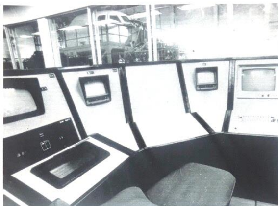
Полноразмерный стенд отработки бортового оборудования МКС «Буран». Пультый комплекс управления испытаниями (фрагмент)
