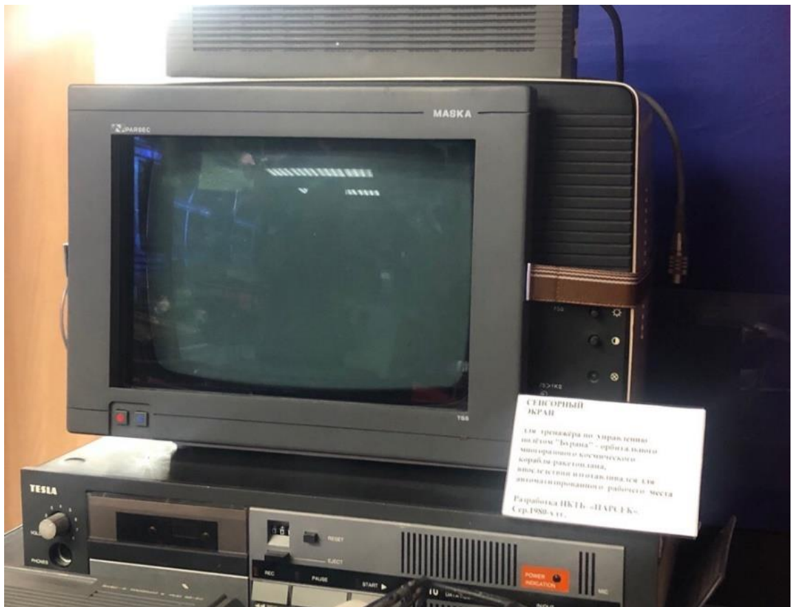
Рисунок 5 – Сенсорный экран для тренажера по управлению полетом «Буран»
