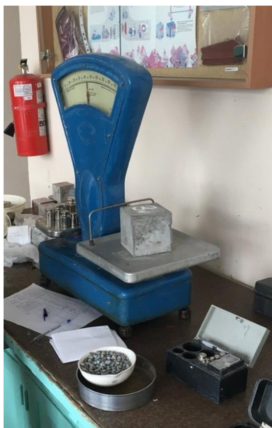
Рисунок 15 – Взвешивание образцов-кубов перед испытаниями №1
