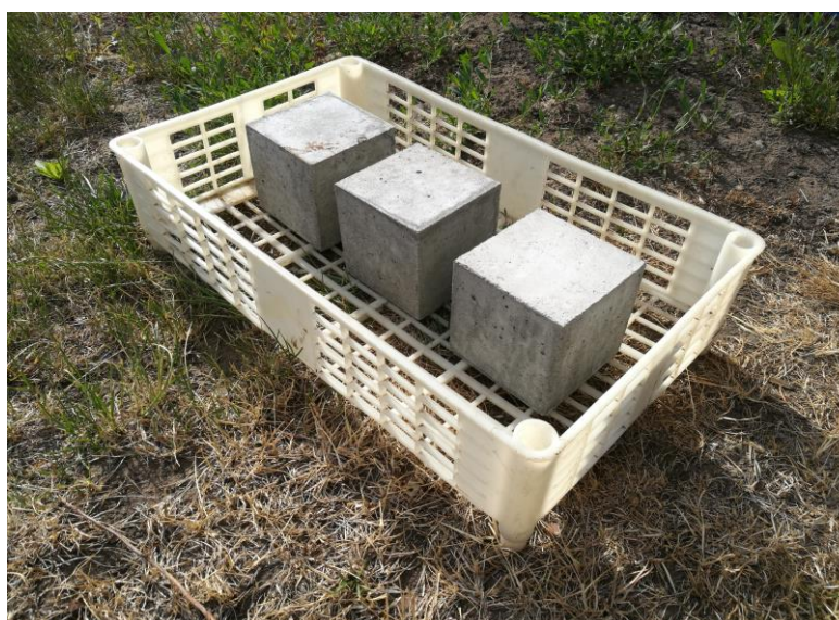
Рисунок 13 – Условия хранения опытных образцов серии 3 (отображена часть образцов)
