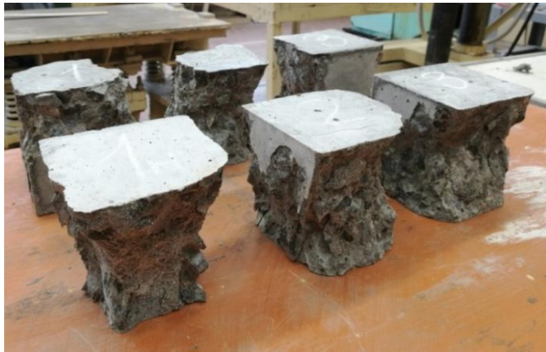
Рисунок 18 – Разрушенные образцы-кубы испытания №1
