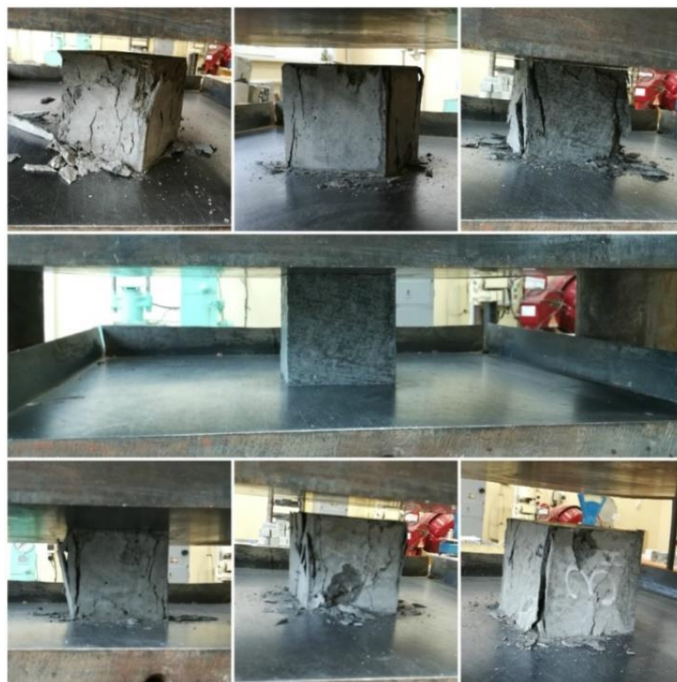
1, 2, 3 – кубы, выдержанные на условной строительной площадке; 4 – куб перед испытанием на прессе; 5, 6, 7 – кубы, выдержанные в благоприятных условиях
