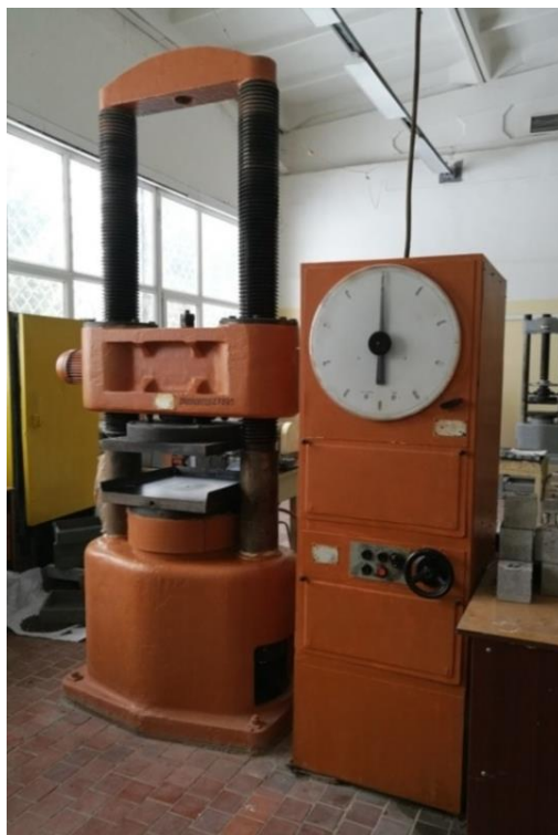
Рисунок 16 – Вид испытательного гидравлического прессы П-250
