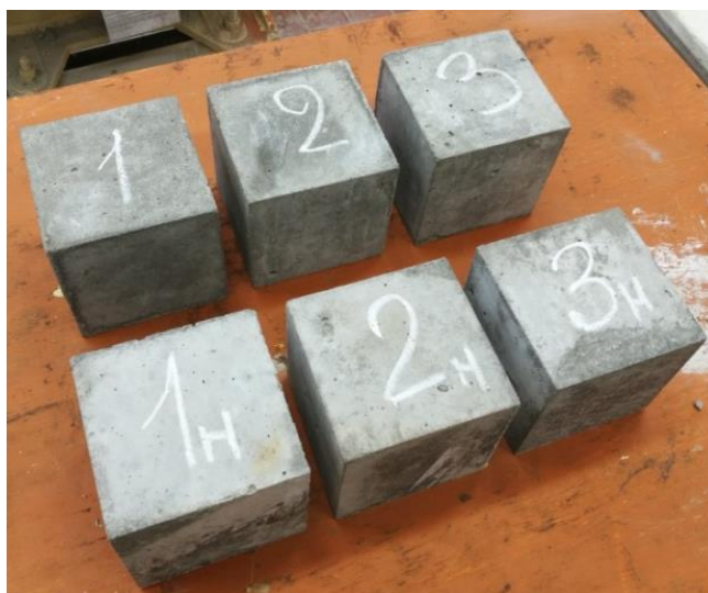
1, 2, 3 – кубы, выдержанные на условной строительной площадке; 1н, 2н, 3н – кубы, выдержанные в благоприятных условиях
