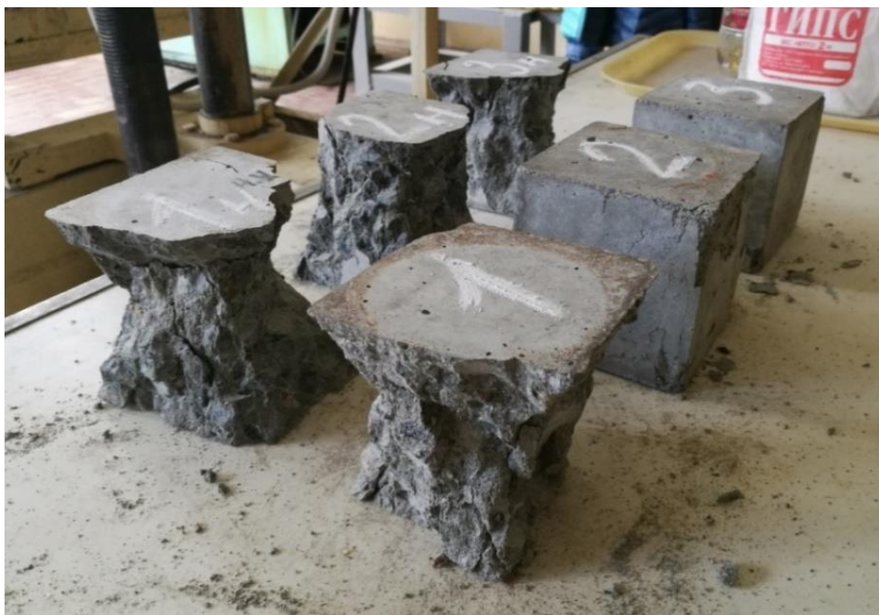
Рисунок 22 – Разрушенные образцы-кубы испытания №2
