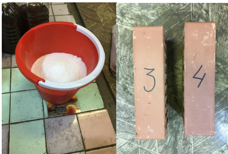
Рисунок 31 – Ёмкость №2 – взвешивание сухих гранул карбамида и погружаемые образцы
