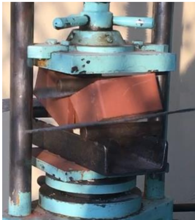
Рисунок 39 – Хрупкое разрушение образца № 1.1 по схеме испытания на изгиб
