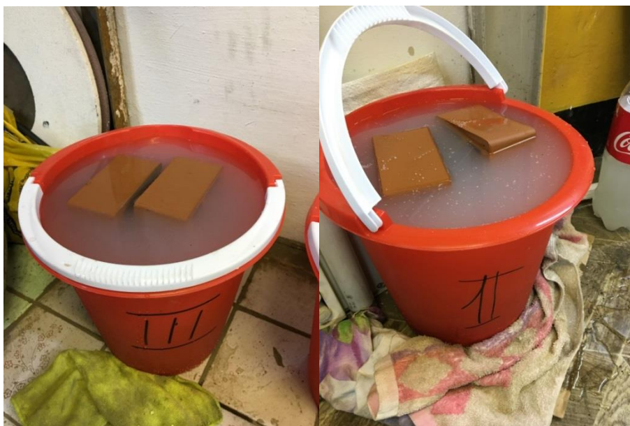
Рисунок 34 – Выдерживание кирпичных образцов в водных растворах карбамида марки Б
