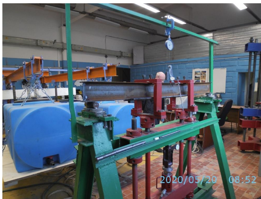
Рисунок 26 – Вид усиленной балки из серии №2 после испытания
