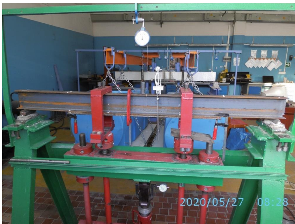
Рисунок 22 – Установленная на опоры установки балка серии №3
