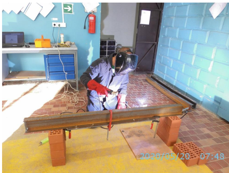
Рисунок 20 – Прикрепление полосы к нижнему поясу испытываемой балки серии №2.
