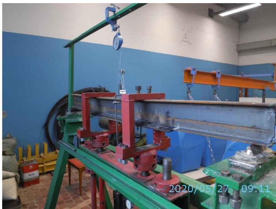
Рисунок 28 – Вид усиленной балки серии №3 после испытания
