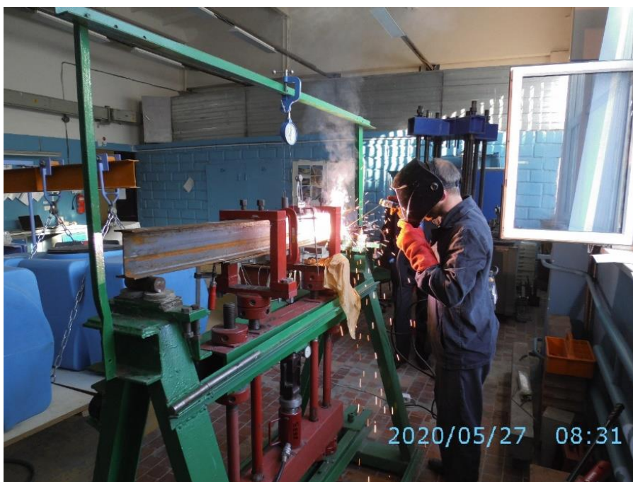
Рисунок 23 – Прикрепление полосы к нижнему поясу балки серии №3
