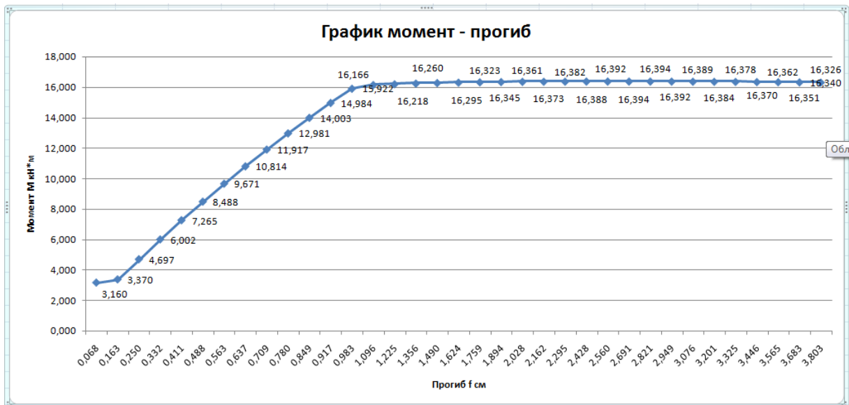
Рисунок А.2 – График момент – прогиб после образования трещин (стадия 2 и 3)
