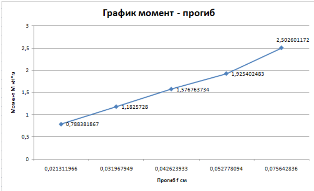
Рисунок А.1 – График момент – прогиб до образования трещин (стадия 1)
