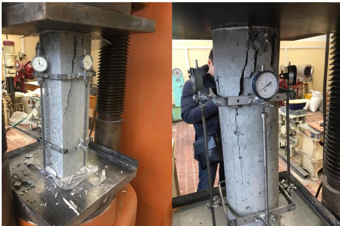
Рисунок 16 – Общий вид бетонных образцов во время разрушения
