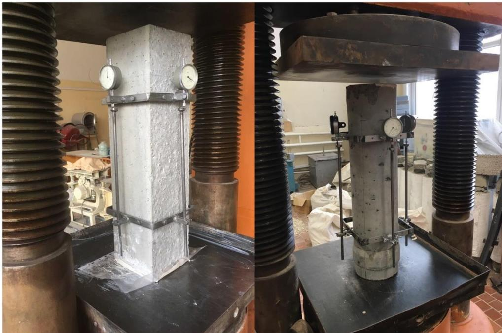
Рисунок 16 – Общий вид образцов с установленными индикаторами часового типа
