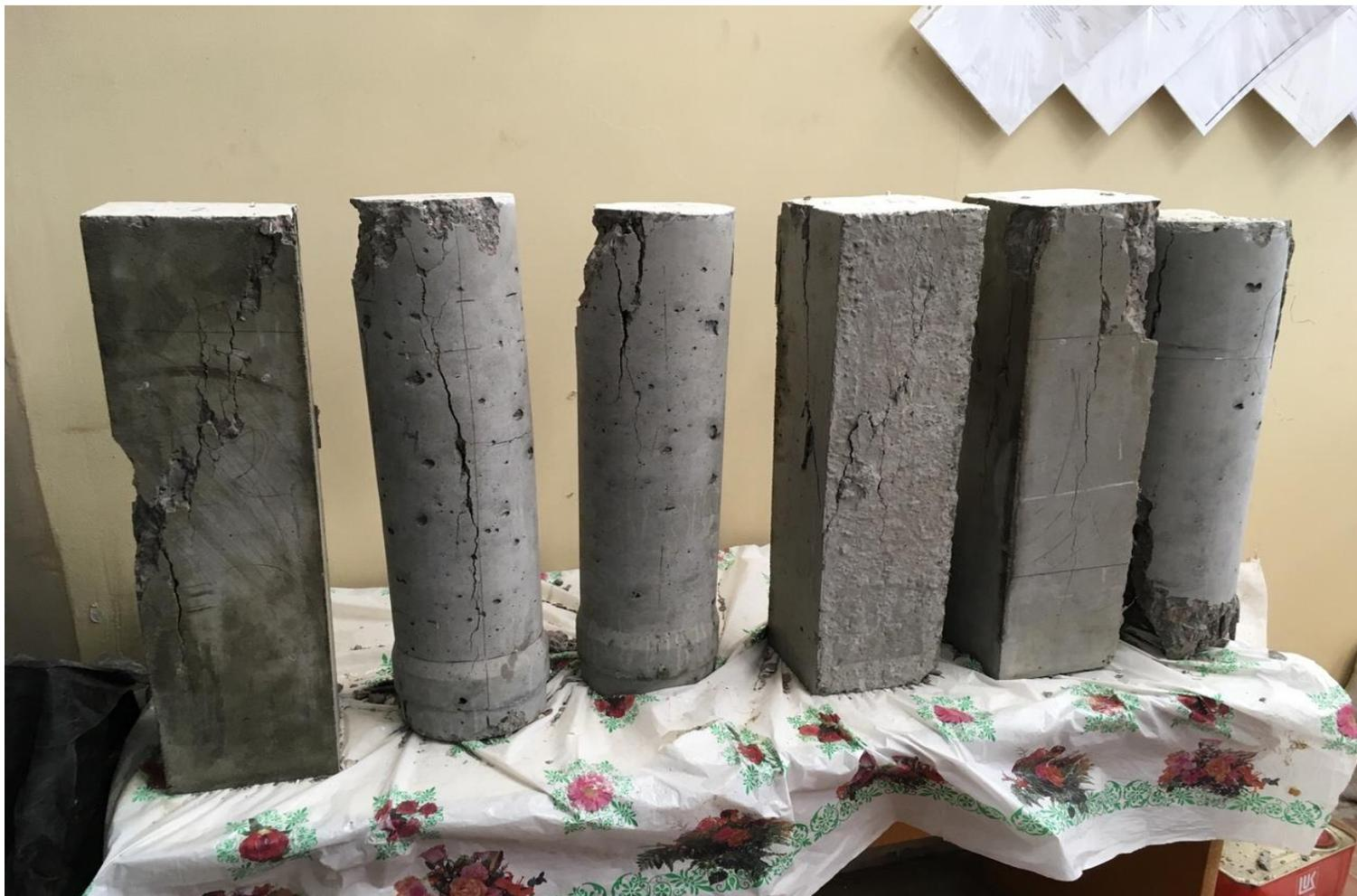
Рисунок А6 – Образцы после проведенных испытаний
