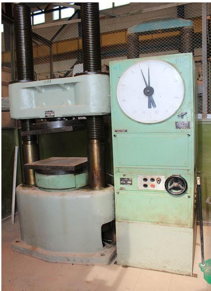
Рисунок 17 – Пресс гидравлический МОД П-250
