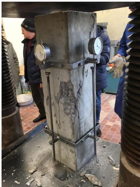
Рисунок А2 – Фрагмент разрушения призмы №1
