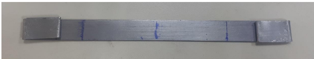
Рисунок 12. Образец по ГОСТ 11701-84.
