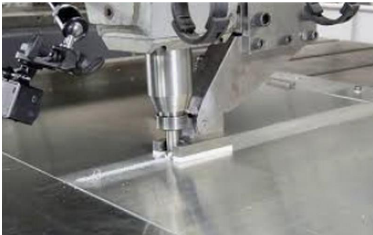
Рисунок 2. Лазерная сварка листовых заготовок.
