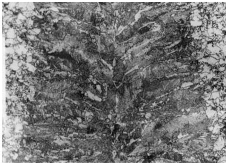
Рисунок 7. Микроструктура сварного шва, полученного лазерной сваркой.
