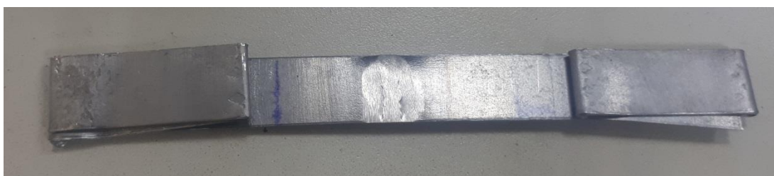
Рисунок 13. Образец по ГОСТ 6996-66.
