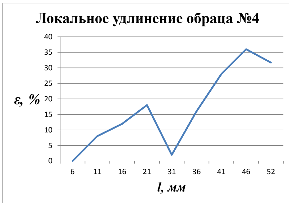
Рисунок 33. График локального удлинения по зонам, образца №4. Область деления 31 – область сварного шва.
