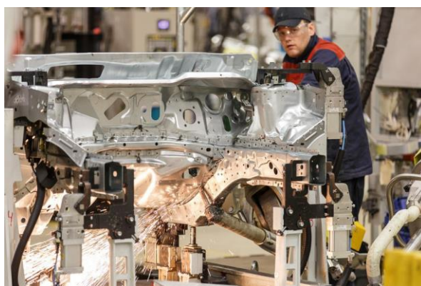
Рисунок 1.17 – Сварка элементов кузова в кондукторе
