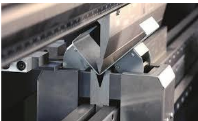
Рисунок 1.14 – Технология изготовления лонжеронов гибкой.
