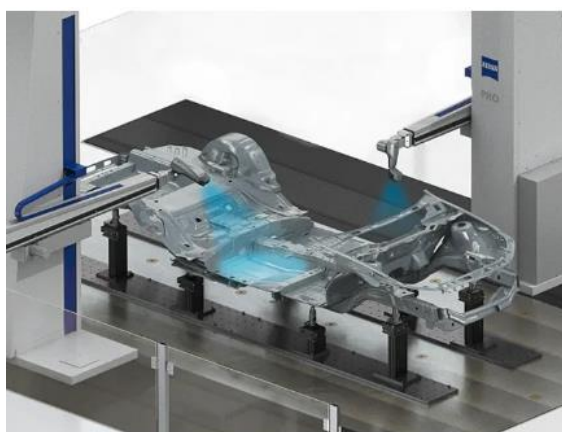
Рисунок 1.20- Контроль геометрии крупно-узлового элемента кузова
