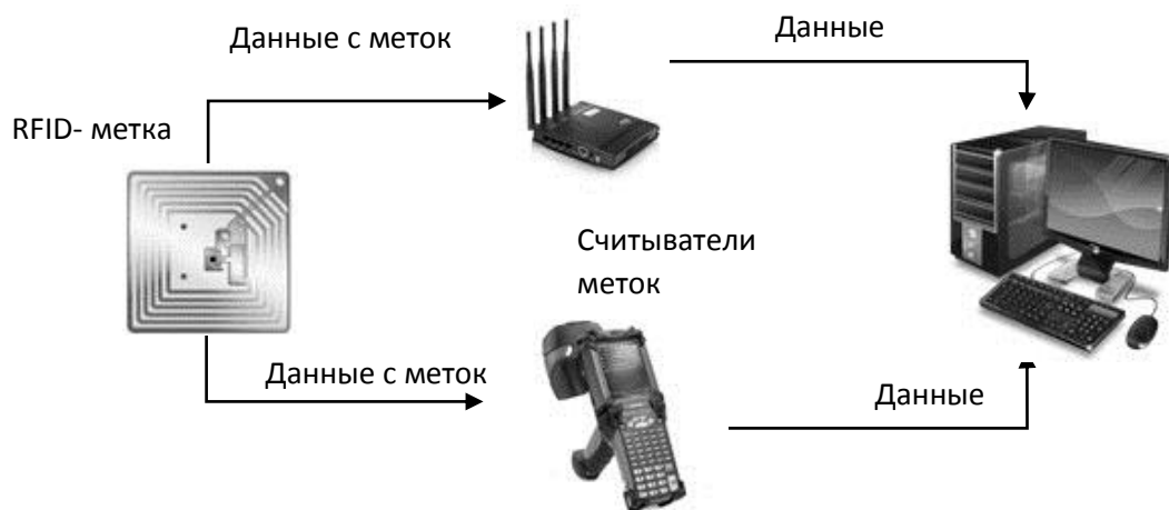
Рисунок 35 – Принцип работы RFID-системы
