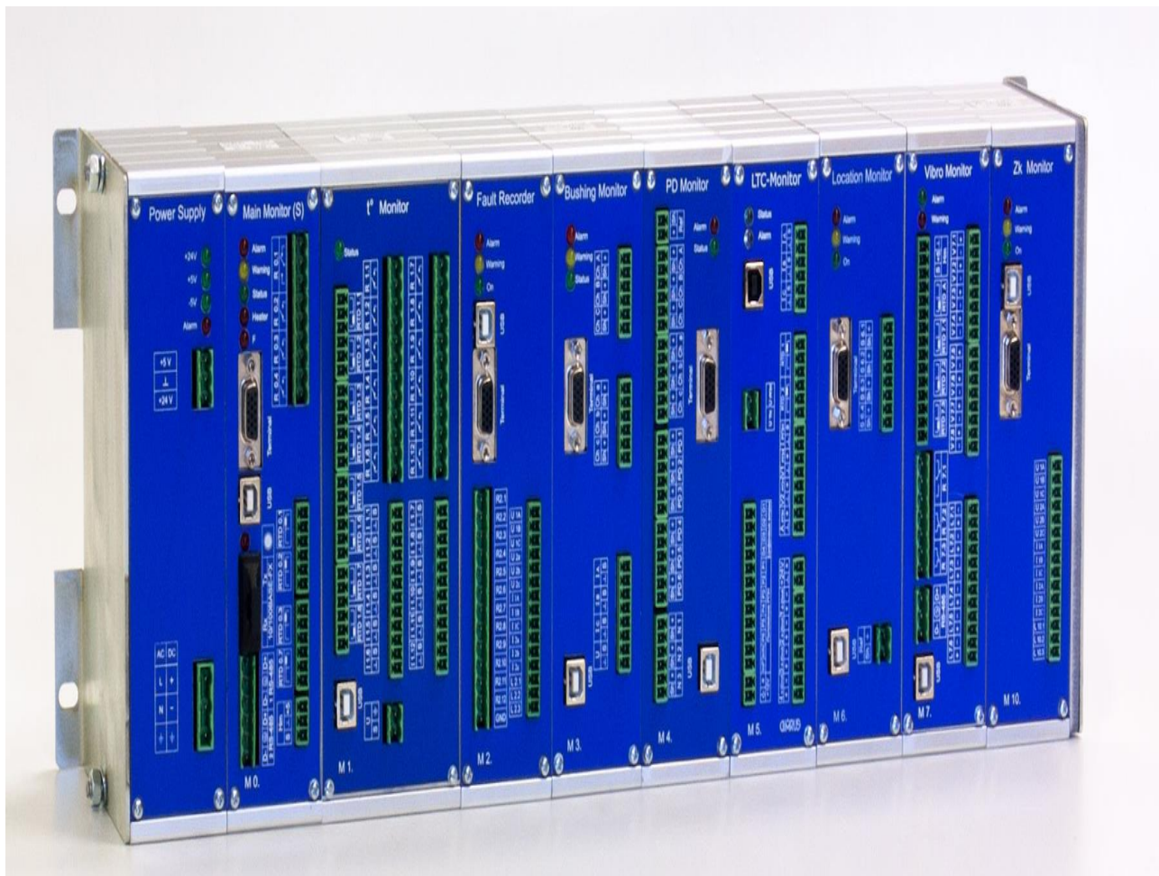
Рисунок 26 – Модульная структура блока мониторинга
