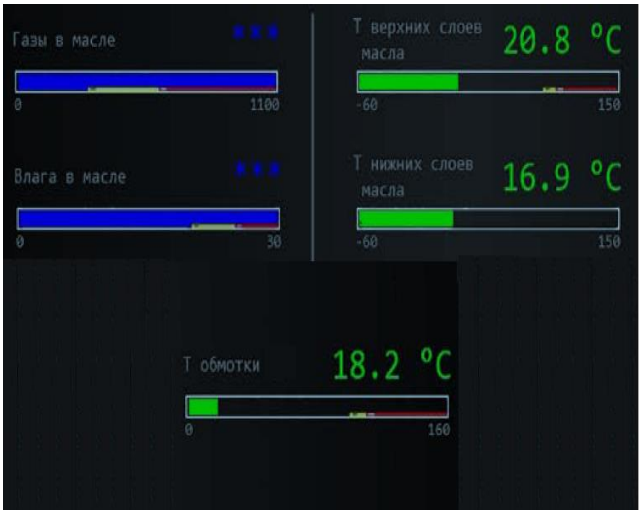
Рисунок 35 – Пример отображения состояния активной части трансформатора
