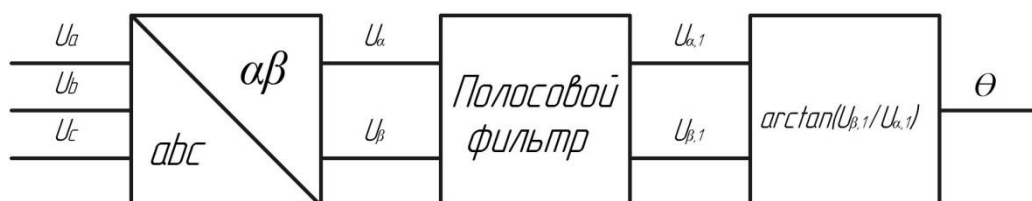
Рисунок 10 – Функциональная схема синхронизации с трехфазным сетевым напряжением методом на основе функции арктангенса
