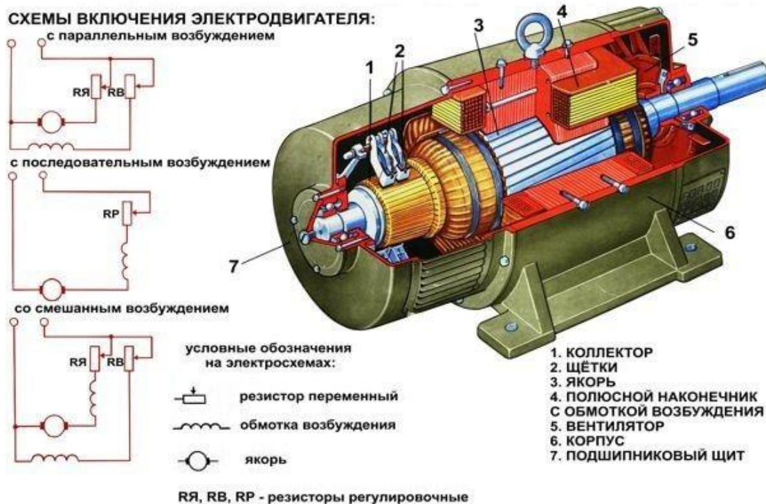
Рисунок 2. Коллекторный двигатель постоянного тока
