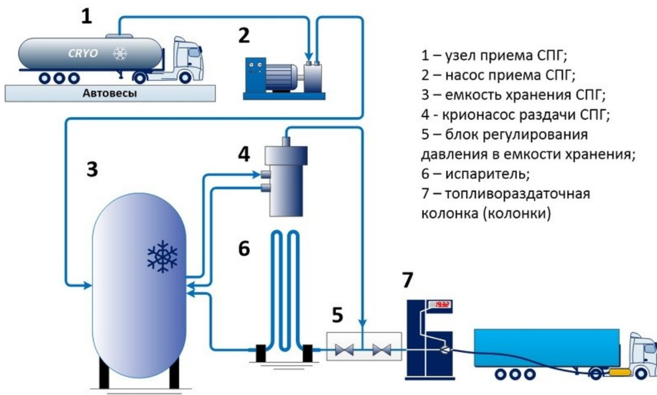
Рисунок 5 – Схема работы криогенной АЗС
