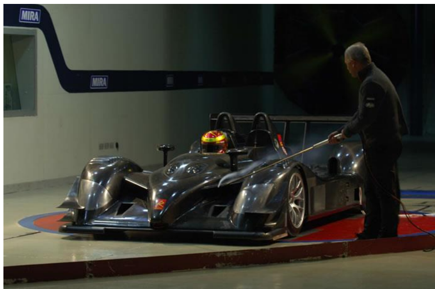
Рисунок 21. Полномасштабная модель болида в аэродинамической трубе.
