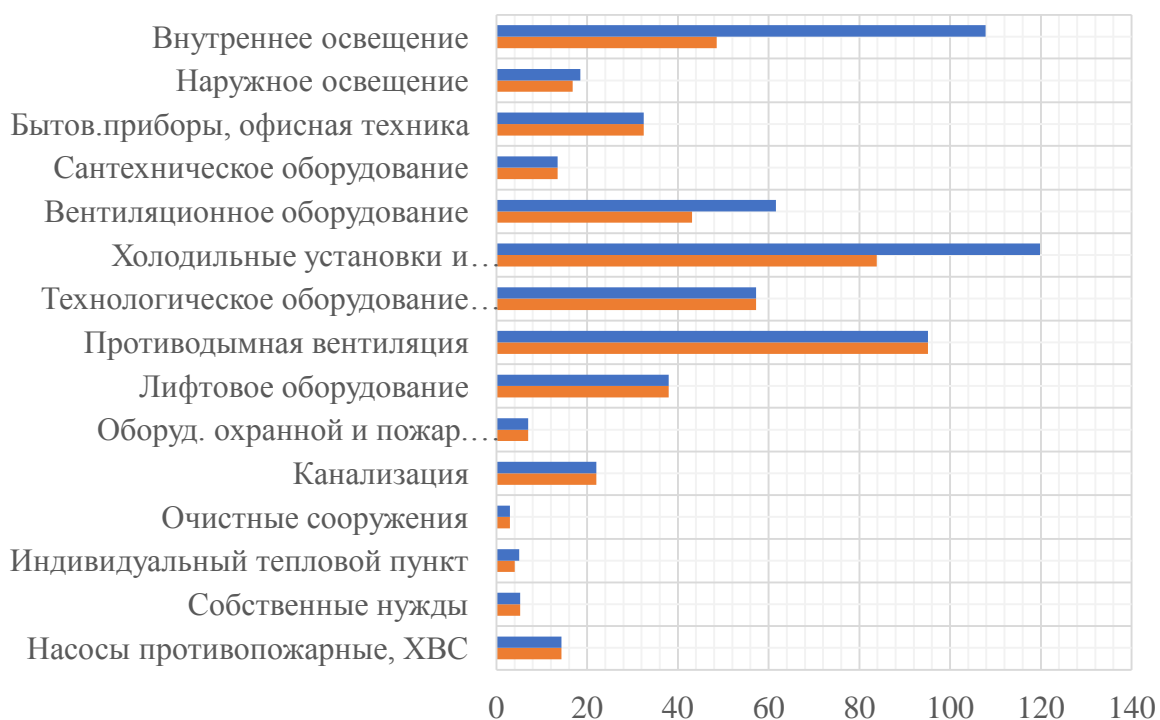
Рисунок 33 – График изменения электрических нагрузок (кВт) при внедрении энергосберегающих мероприятий
