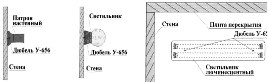
Рисунок 9- Монтаж светильников и наружных патронов на ровные основания
