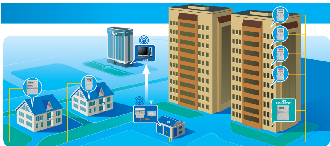
Рисунок 1.4 – Структурная схема АИИСКУЭ коммунальных потребителей с передачей данных по силовой сети (PLC)
