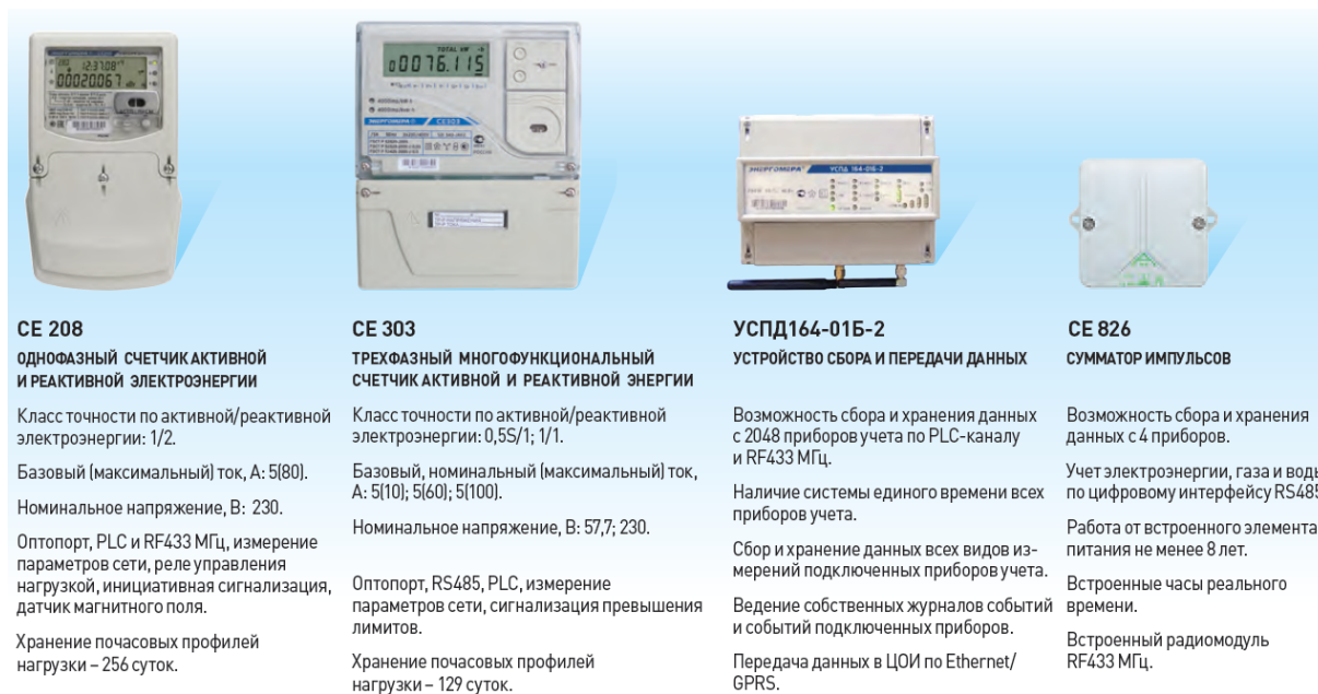
Рисунок 3.5 – Оборудование АИИСКУЭ коммунальных потребителей с интеллектуальным учетом энергоресурсов
