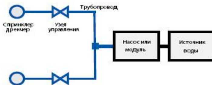
Рисунок 10 - Схема построения установки HI-FOG®
