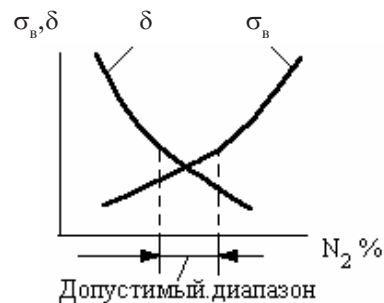
Рис. 1. Пример решения технологической задачи — выбор допустимого диапазона концентрации азота в сварном шве
