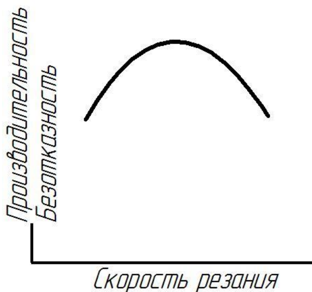
Рисунок 12 - Скорость производства/доступность в зависимости от скорости резания для отдельного станка
