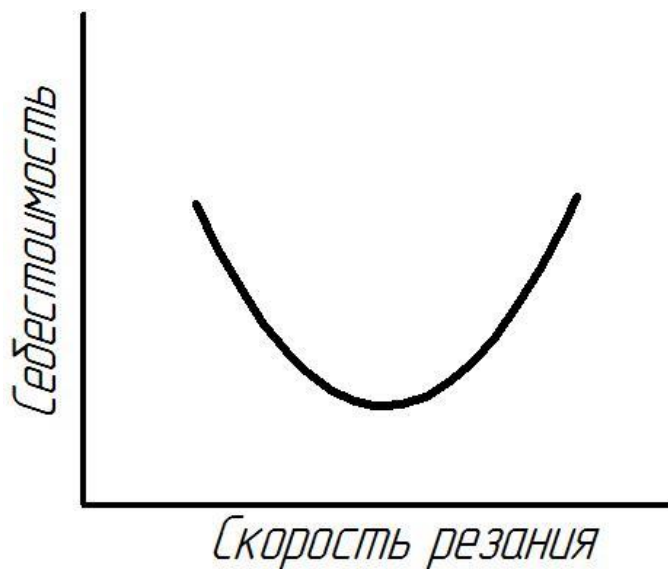
Рисунок 9 - Стоимость обработки как функция скорости резания
