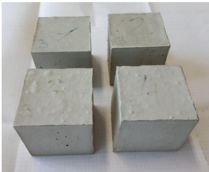
Рисунок 2.6 - Образцы кубов размером 70x70x70
