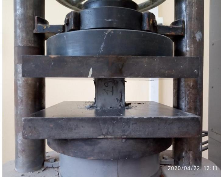
Рисунок 3.2- Процесс испытаний образцов на предел прочности
