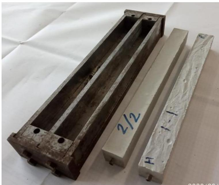
Рисунок 2.7 - Формы и готовые образцы для определения деформации усадки
