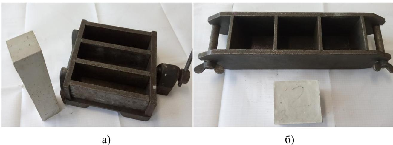
Рисунок 2.2 - «Формы для изготовления контрольных образцов бетона»
