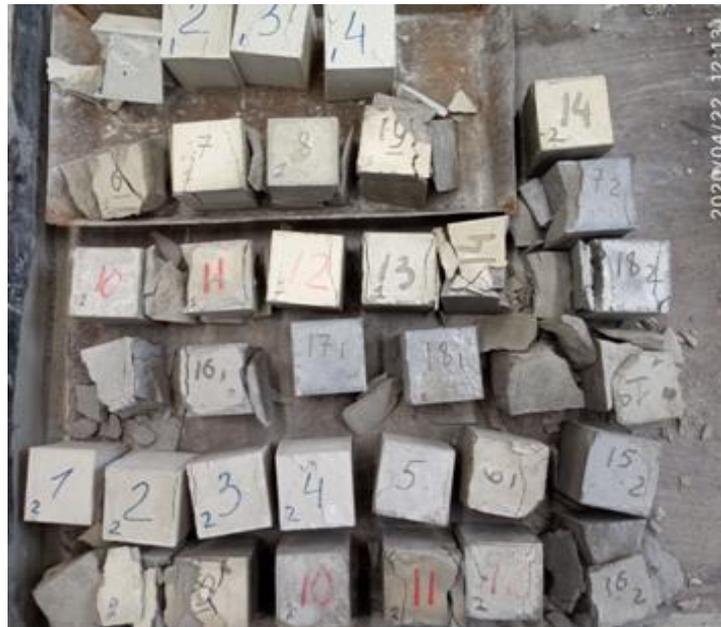
Рисунок 3.3 - Внешний вид образцов после испытания на прочность при сжатии
