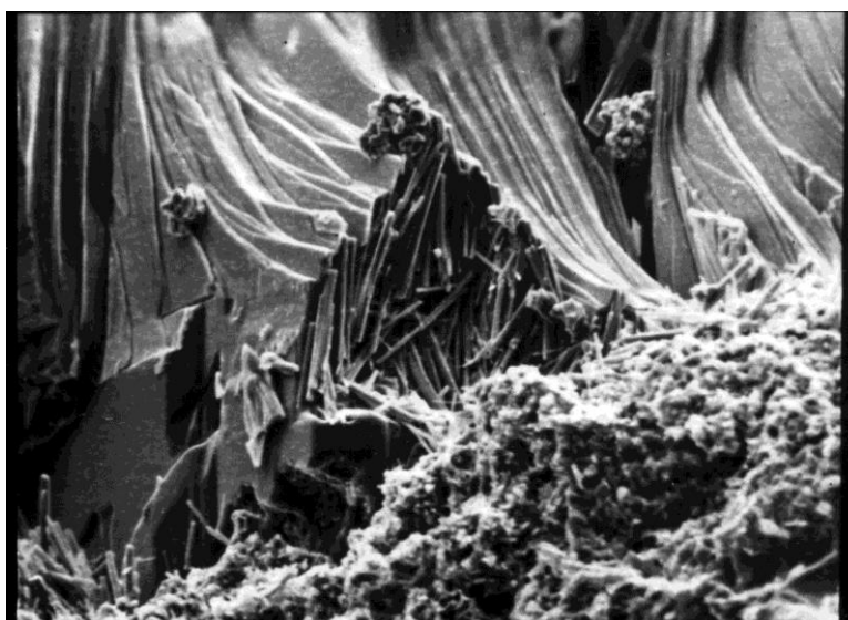
Рисунок 3.3 – Разъедание зерна гипса с образованием этtringита, образец в возрасте 1 год (ув. 1500 x )
