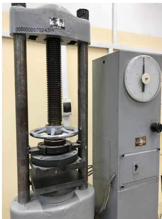
Рисунок 3.7 – Пресс испытаний образца бетона на прочность при сжатии
