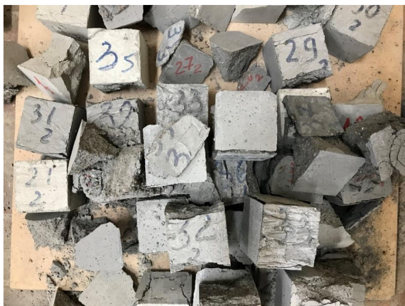
Рисунок 3.10 – Образцы коррозионностойкого бетона после испытания на предел прочности при сжатии
