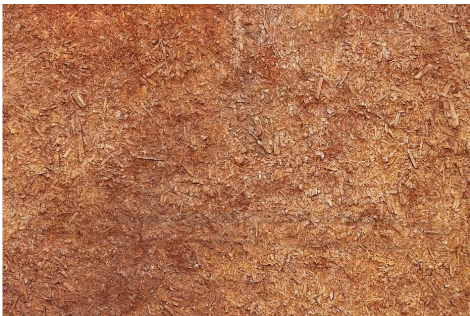
Рисунок 2.3 – Отделочное покрытие с использованием древесных опилок
