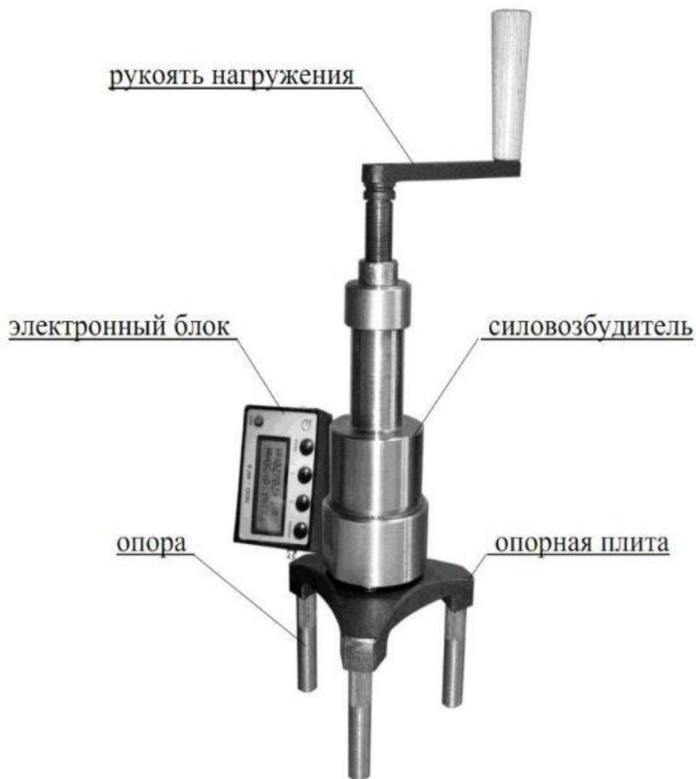
Рисунок 3.4 - Схема проведения испытаний.
