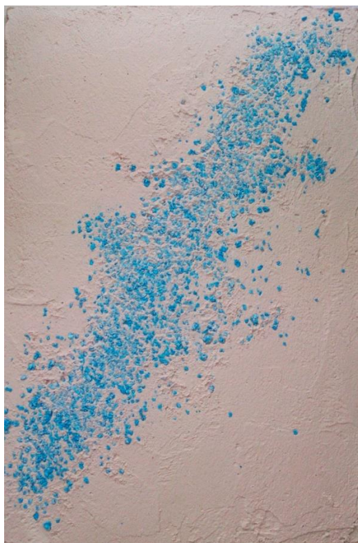
Рисунок 3.7 - Устройство финишного покрытия с использованием яичной скорлупы.
