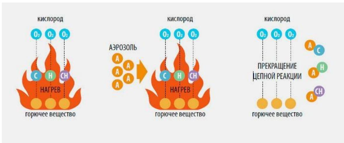
Рисунок 5 – Принцип действия аэрозолеобразующего огнетушащего состава
