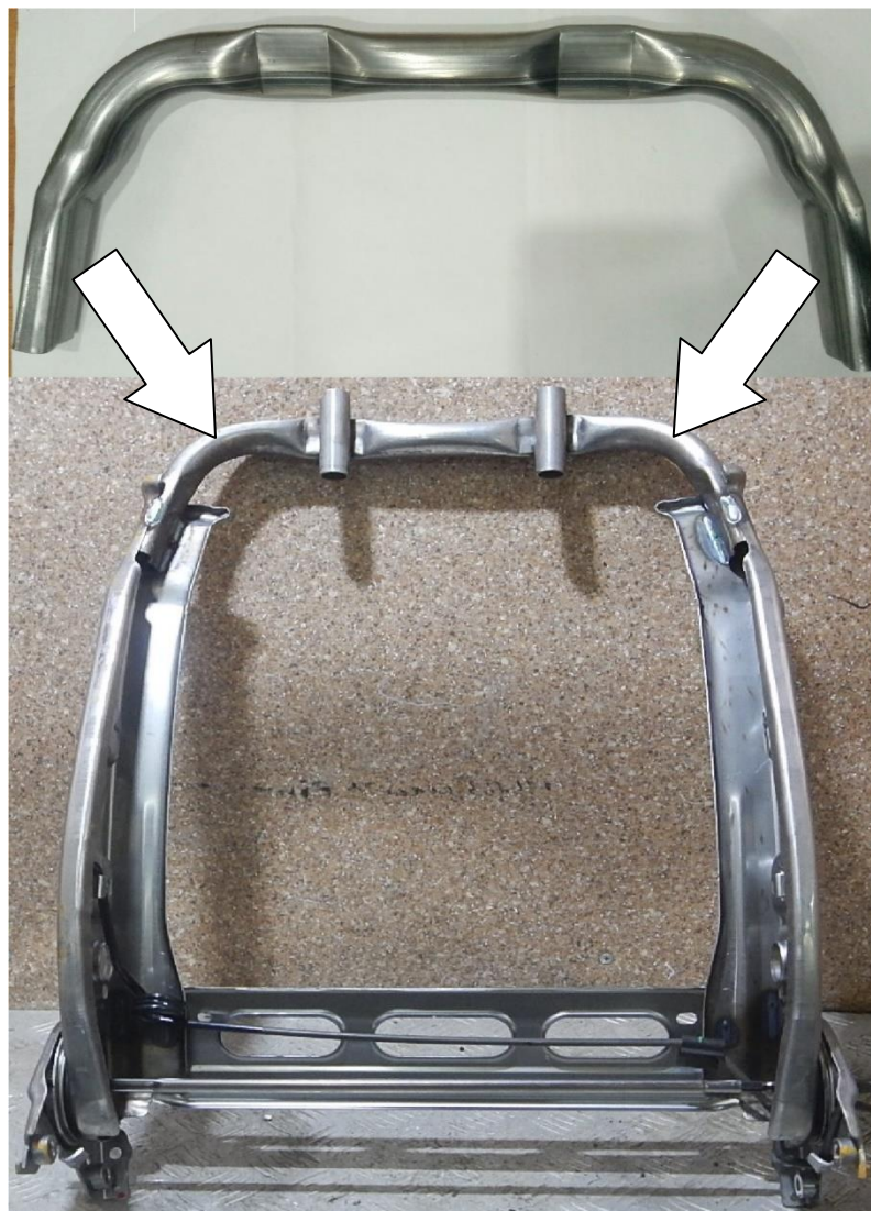
Рисунок 13 – Верхняя трубка каркаса спинки автомобильного кресла
