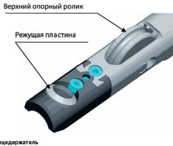
Рисунок 36 – Схема снятия грата при ВЧ-сварке
