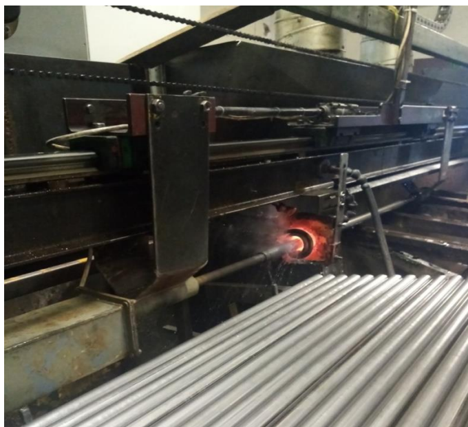
Рисунок 69 – Прохождение трубы через индуктор
