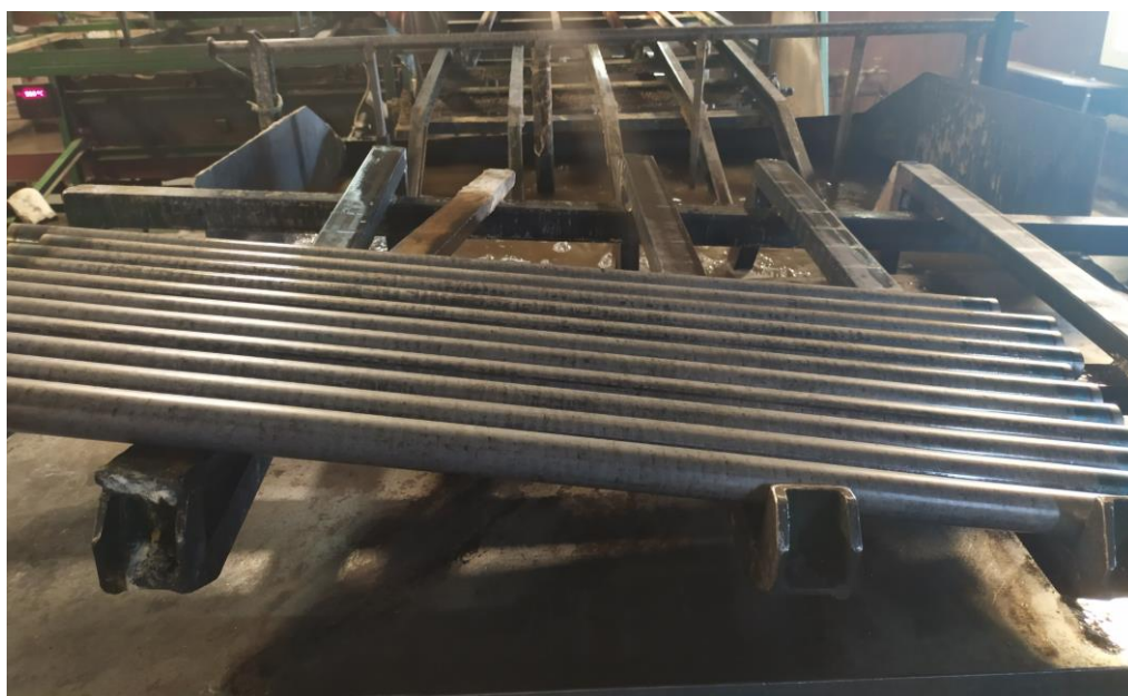
Рисунок 50 – Просушка труб на последнем накопительном рольганге
