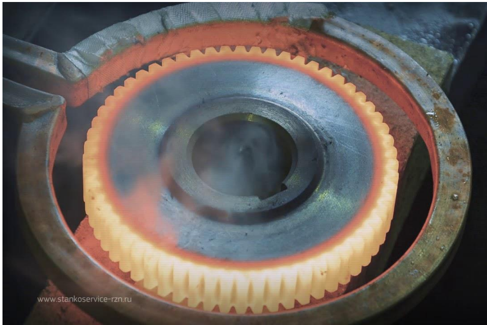
Рисунок 40 – Закалка ТВЧ зубьев шестерен
