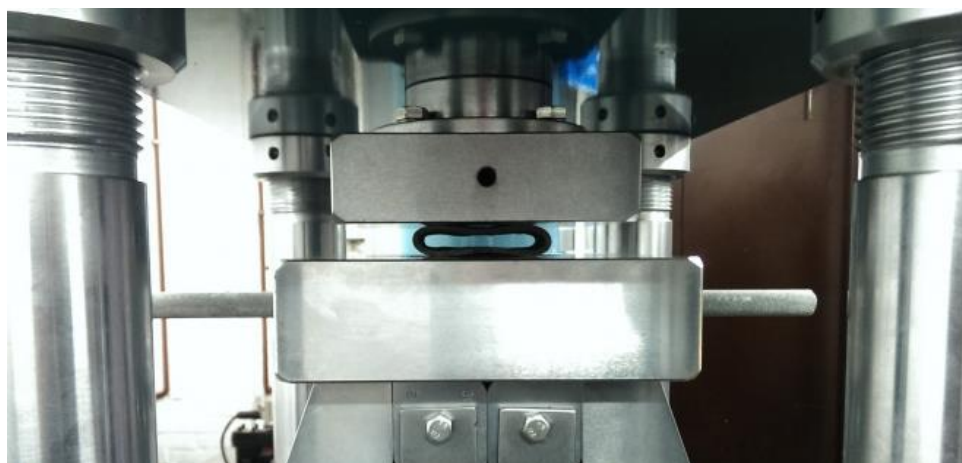
Рисунок 52 – Процесс испытания трубы на сплющивание
