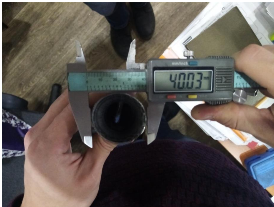
Рисунок 77 – Раздача образца №11-1 до 40,03 мм (без трещин)
