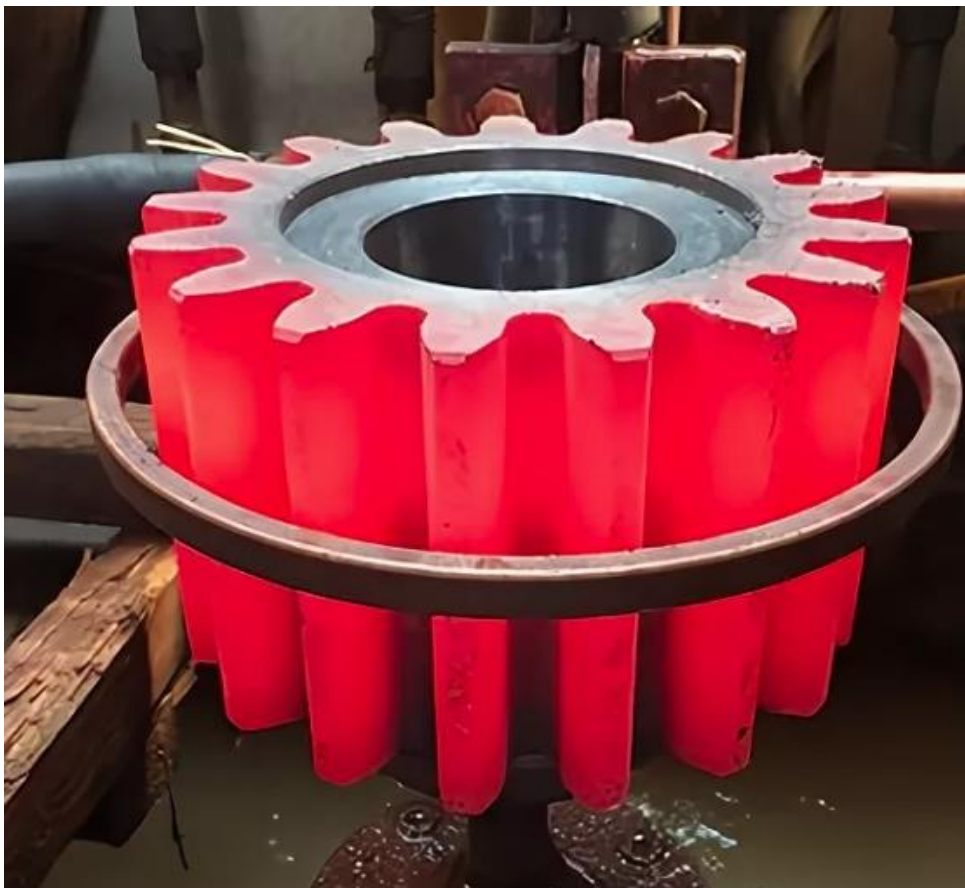
Рисунок 41 – Закалка ТВЧ зубчатых колес
