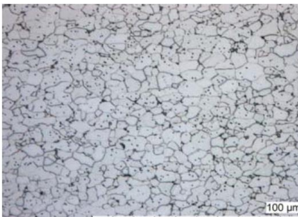
Рисунок 62 – Образец требуемой микроструктуры по стандарту заказчика ТЕР 320
