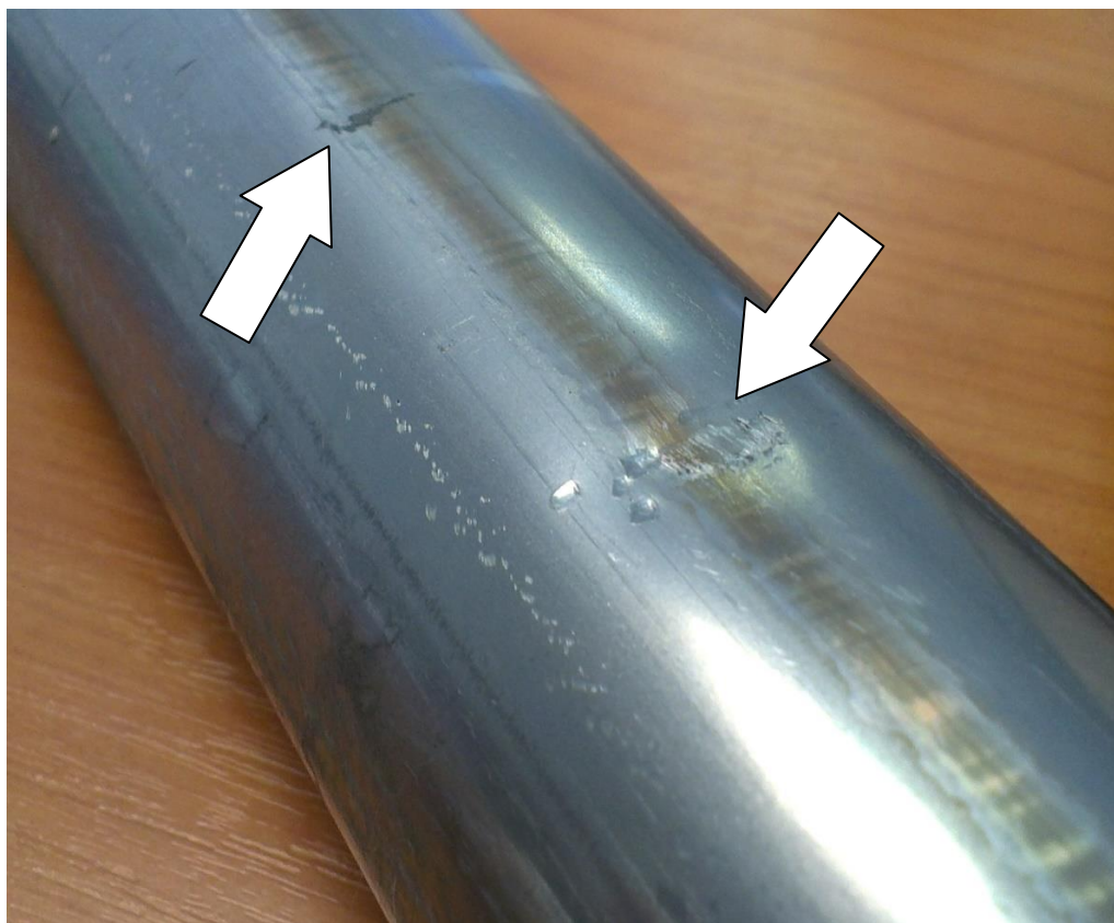
Рисунок 21 – Вмятины на поверхности электросварной трубы
