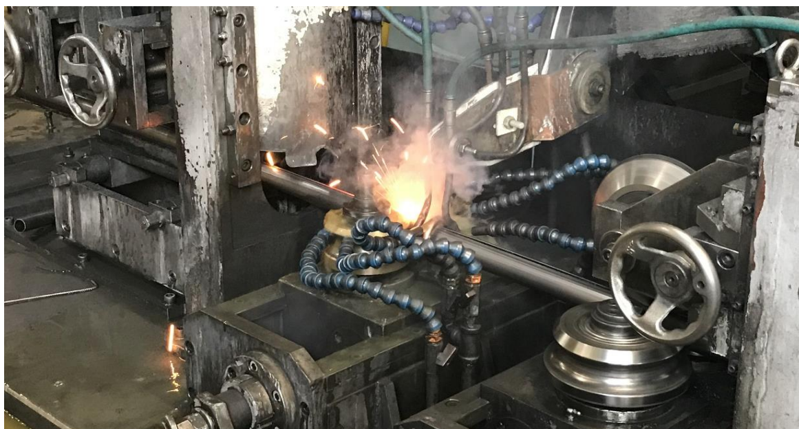
Рисунок 34 - Процесс стыковки и сварки кромок трубной заготовки
