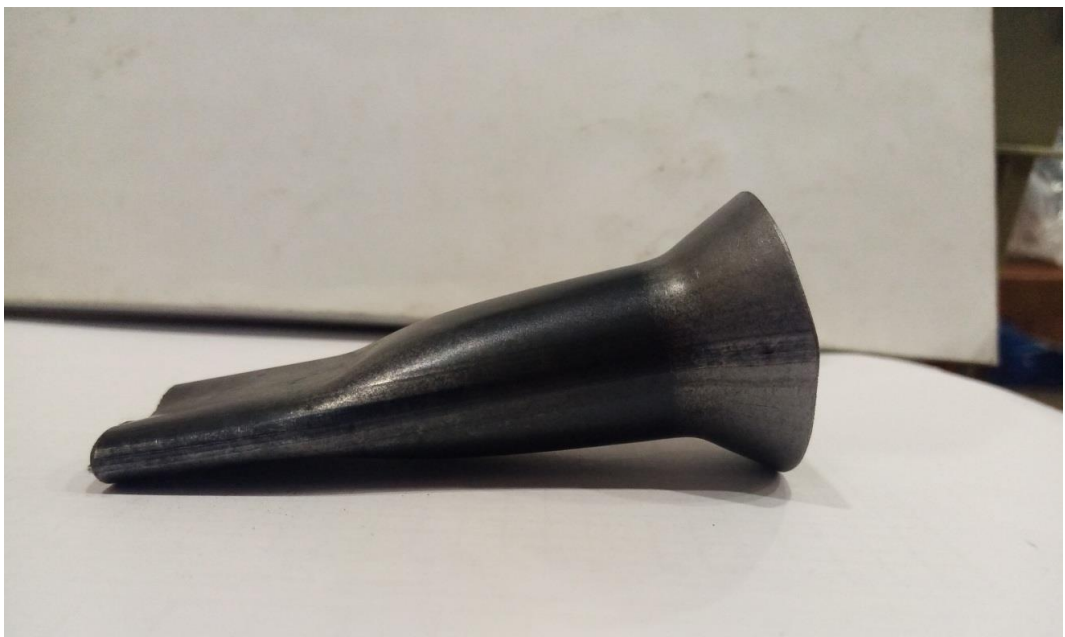
Рисунок 80 – Сплющивание образца №11-2 без трещин по сварному шву
