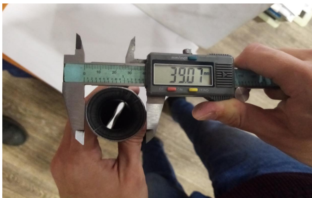
Рисунок 78 – Раздача образца №11-2 до 39,07 мм (без трещин)
