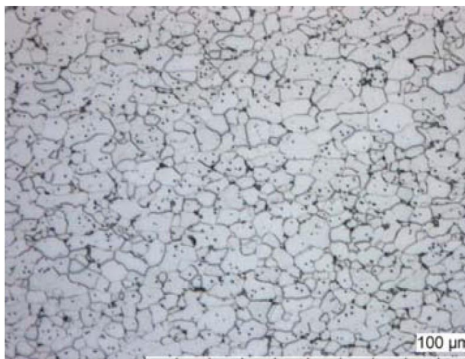
Рисунок 17 – Требуемая микроструктура стали по стандарту TEF 320 [6]
