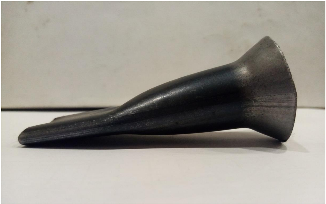
Рисунок 79 – Сплющивание образца №11-1 без трещин по сварному шву
