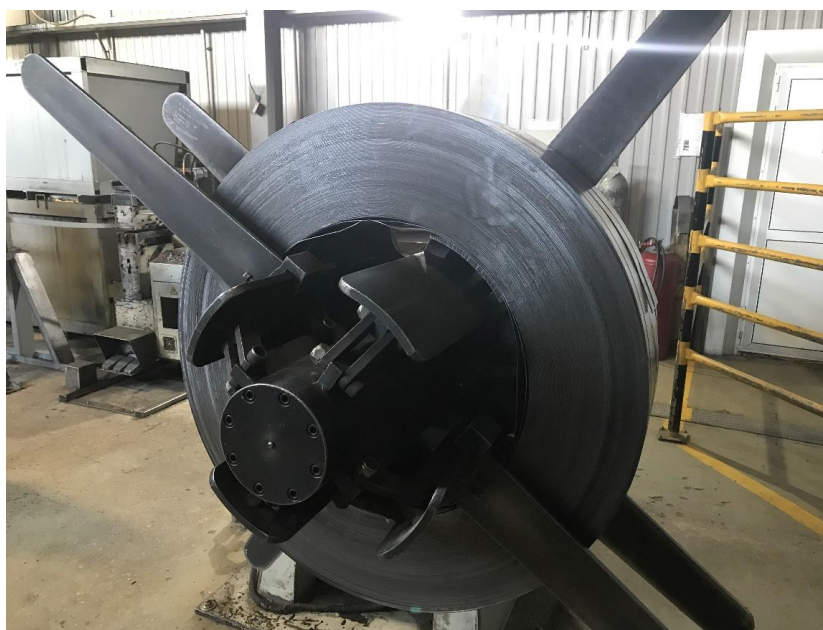
Рисунок 29 – Двойной разматыватель с установленным на него рулоном ленты
