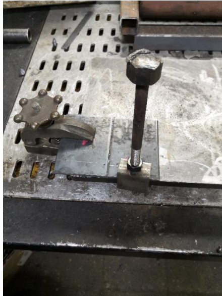
Рисунок 22 – Фиксация пластин для проведения сварки
