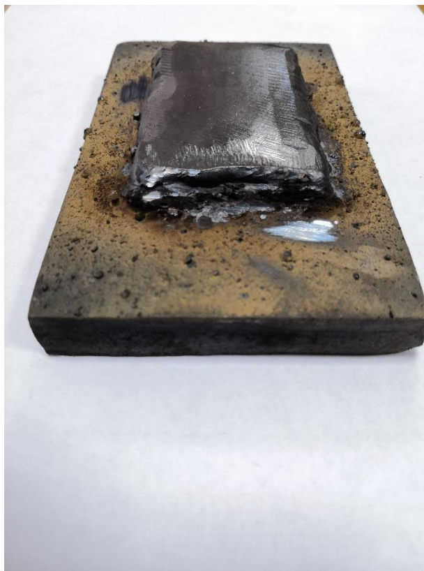
Рисунок 26 – Пятислойная наплавка после зачистки
