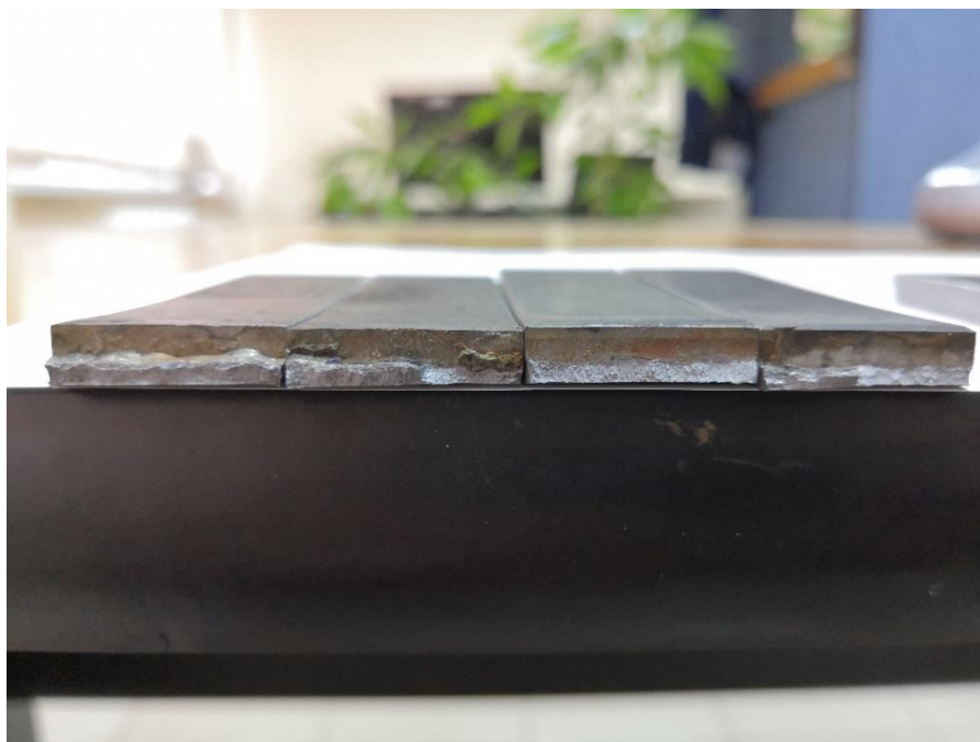
Рисунок 24 – Образцы после разрыва
