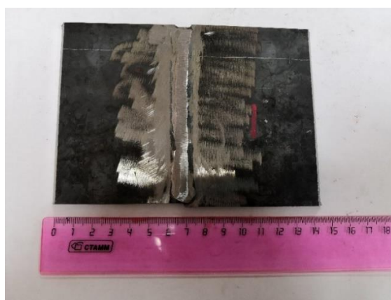
Рисунок 23 – Однослойная сварка с поперечными колебаниями, при измерении ширины валика
