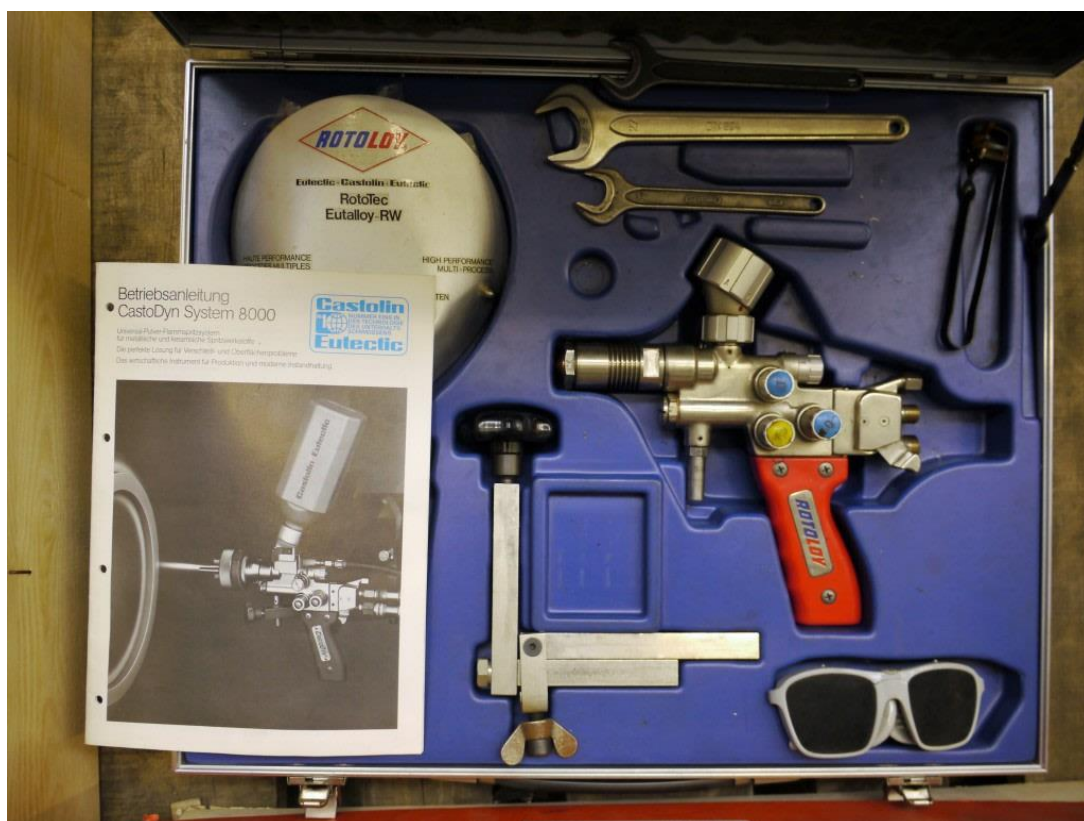
Рисунок 3.8 – Горелка фирмы Кастолин.
