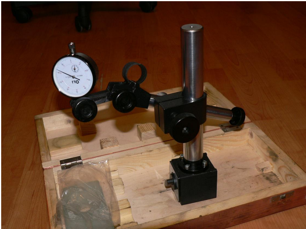
Рисунок 2.4 - Штатив измерительный с головкой индикаторной Схема измерения и основные размеры приведена на рисунках 5, 6, 7.
