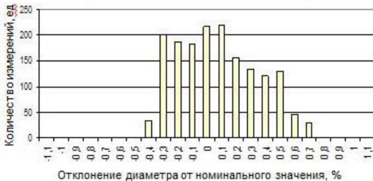
Рисунок 3.8 – Отклонения внутренних диаметров от номинального значения для обечаек, сваренных с применением вибрационной обработки частотой 40 герц.
