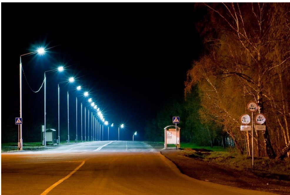
Рисунок 4 – Односторонняя схема расположения фонарных столбов
