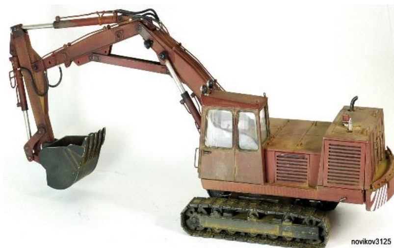
Рисунок 4.1 – одноковшовый экскаватор на гусеничном ходу с обратной лопатой
