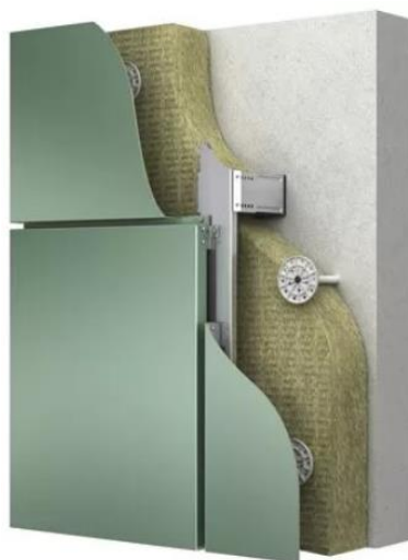
Рисунок 1.2 – Вентилируемый фасад КРАСПАН-Колор.
