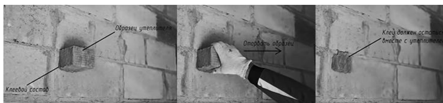
Рисунок 3.1 – Проверка адгезии клеевого состава
