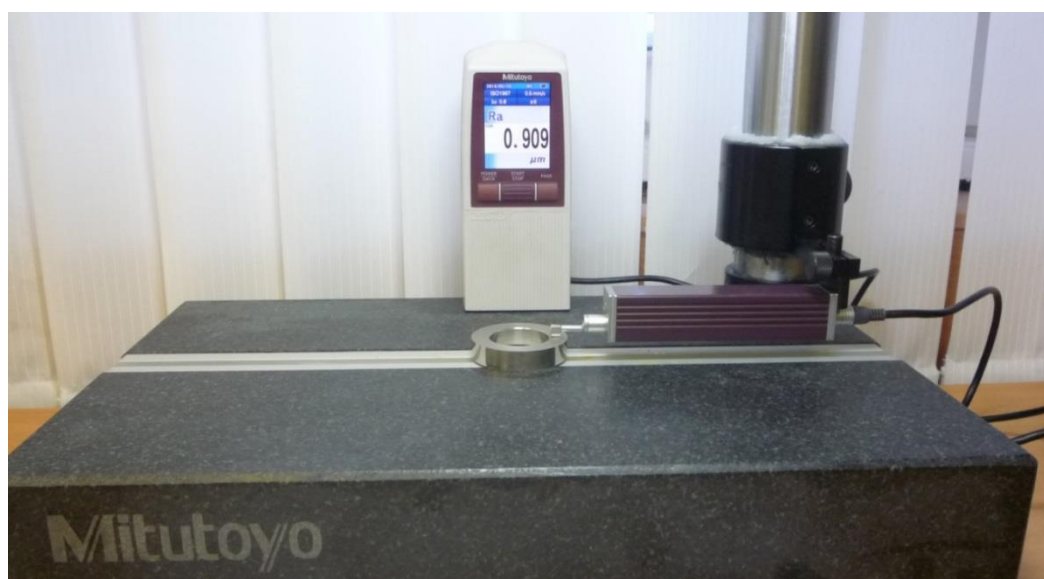
Рисунок 10. – Процесс измерения шероховатости профилометром-профилографом Mitutoyo SurfTest SJ-210
