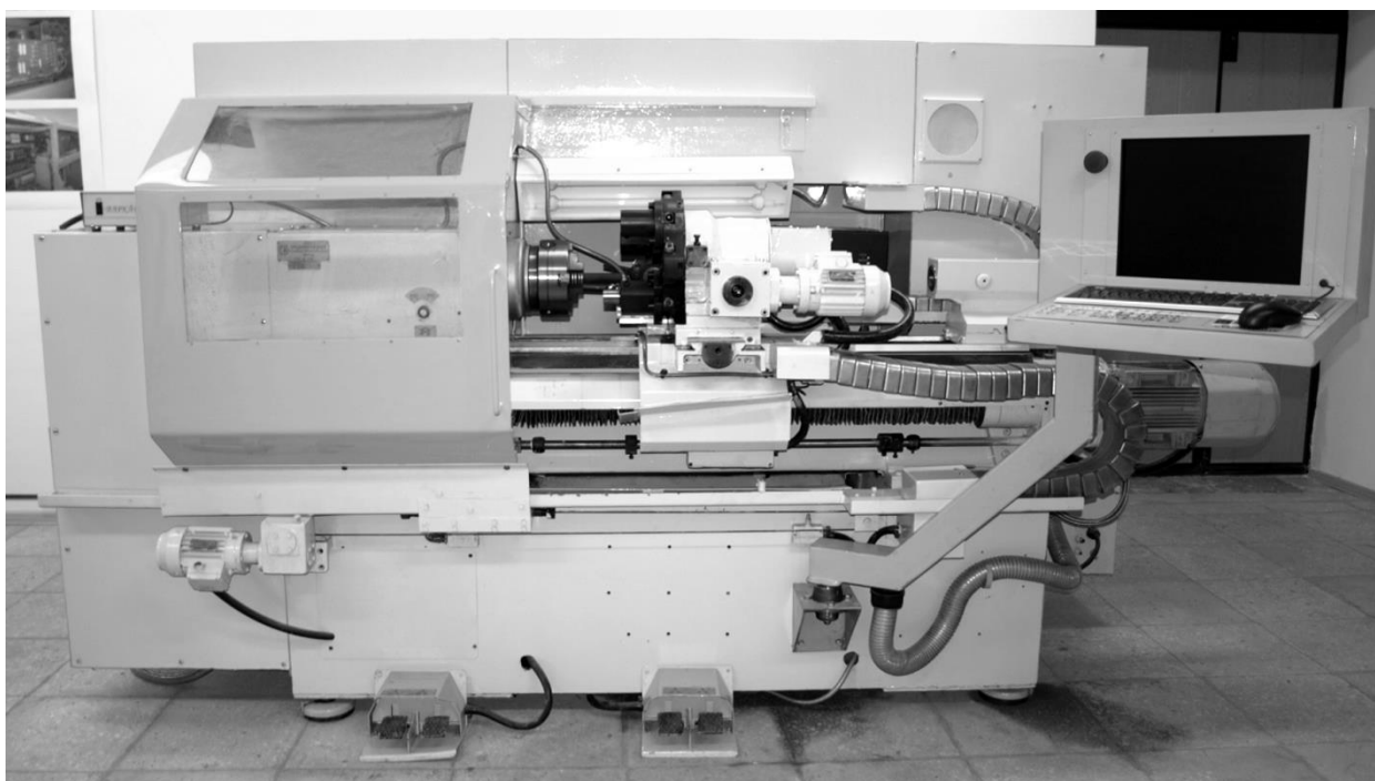
Рисунок 5. – Модернизированный токарный станок с ЧПУ мод. 16П16Т1С1
