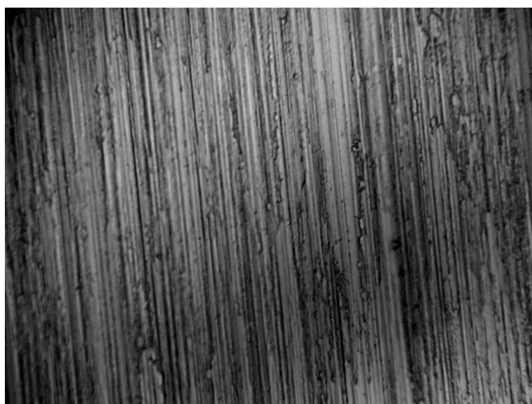
Рисунок 17. – Исходное полутоновое изображение обработанной поверхности
