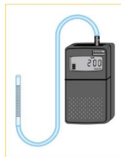
Рисунок 15 – Активный отбор проб при термодесорбции
