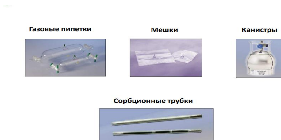
Рисунок 2 – Оборудование, необходимое для термодесорбции/ газовой хроматографии
