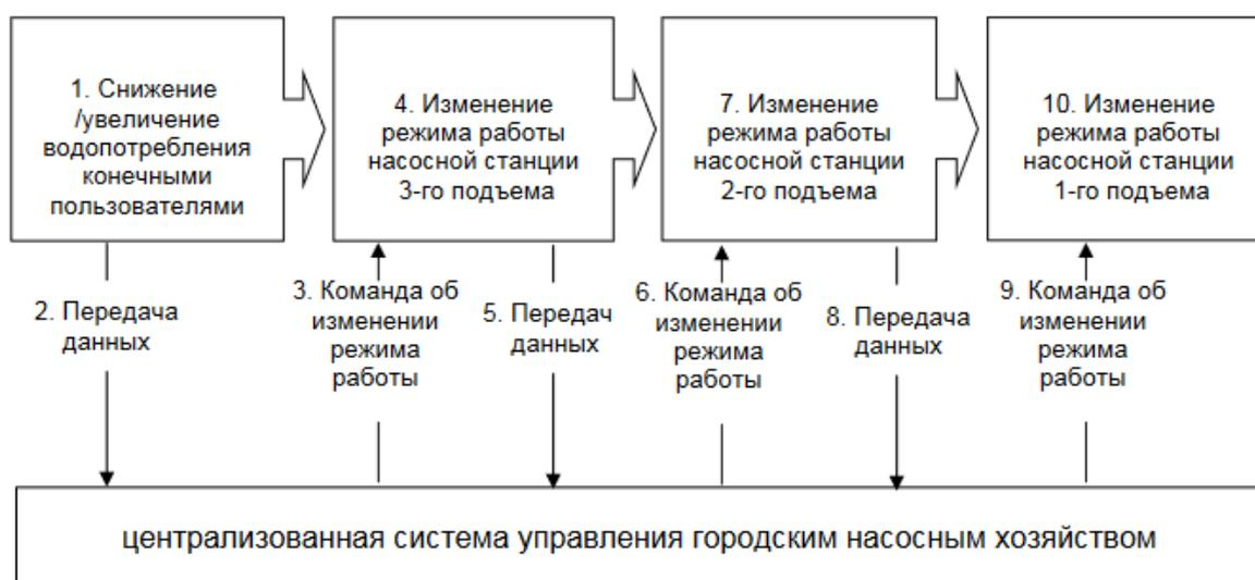
Рисунок 6 – Принцип действия централизованной автоматизированной системы управления городским насосным хозяйством.
