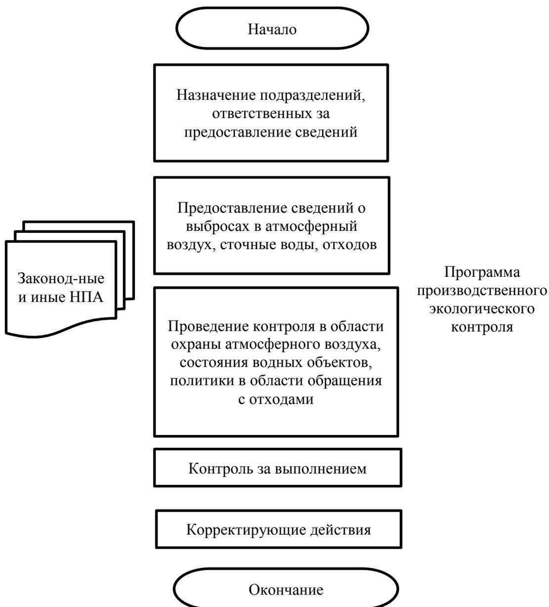
Рисунок 10 - Программа производственного экологического контроля на наливной эстакаде в резервуарном парке 2-го участка цеха № 14 АО «Сызранский НПЗ»
