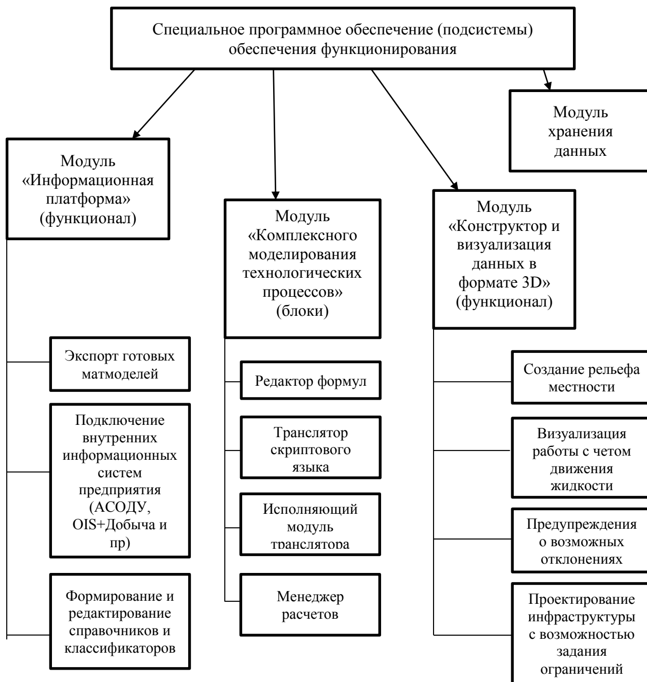
Рисунок 8 - Функциональные модули реализации инженерного симулятора
