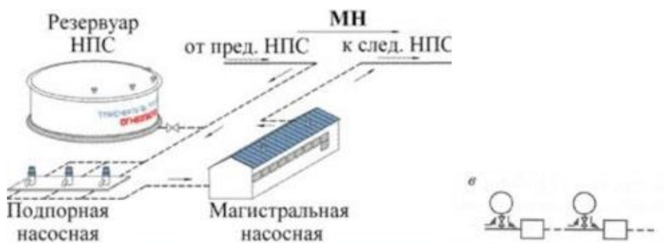
Рисунок 2.1 – Схема перекачки нефти
