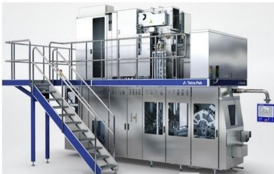
Рисунок 10 – Упаковочный автомат для асептической упаковки жидких продуктов питания Тетра Пак А3 / Компакт
