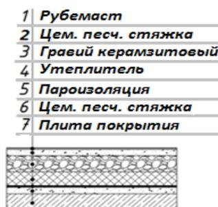
Рисунок 1.3 – Состав покрытия
