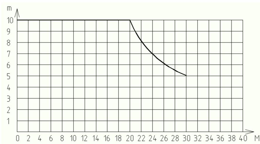
Рисунок 4.1 – график грузоподъемности башенного крана КБ-408
