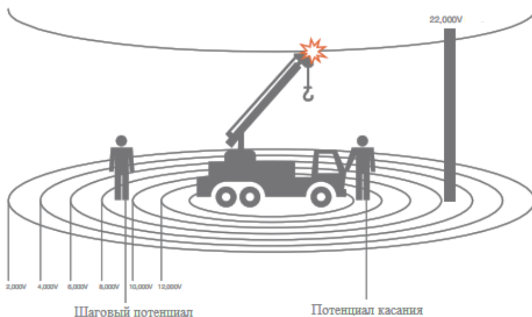
Рисунок 13- Диаграмма рассеивания напряжения
