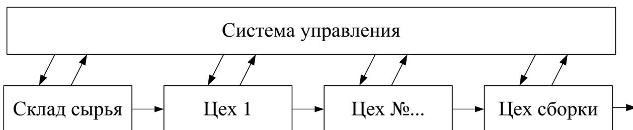
Рисунок 6 – Выталкивающая система управления материальным потоком
