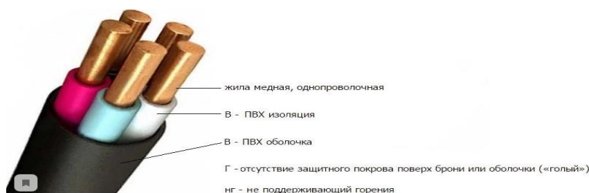
Рисунок 2.6 – Внешний вид, строение и расшифровка аббревиатуры кабеля марки ВВГнг
