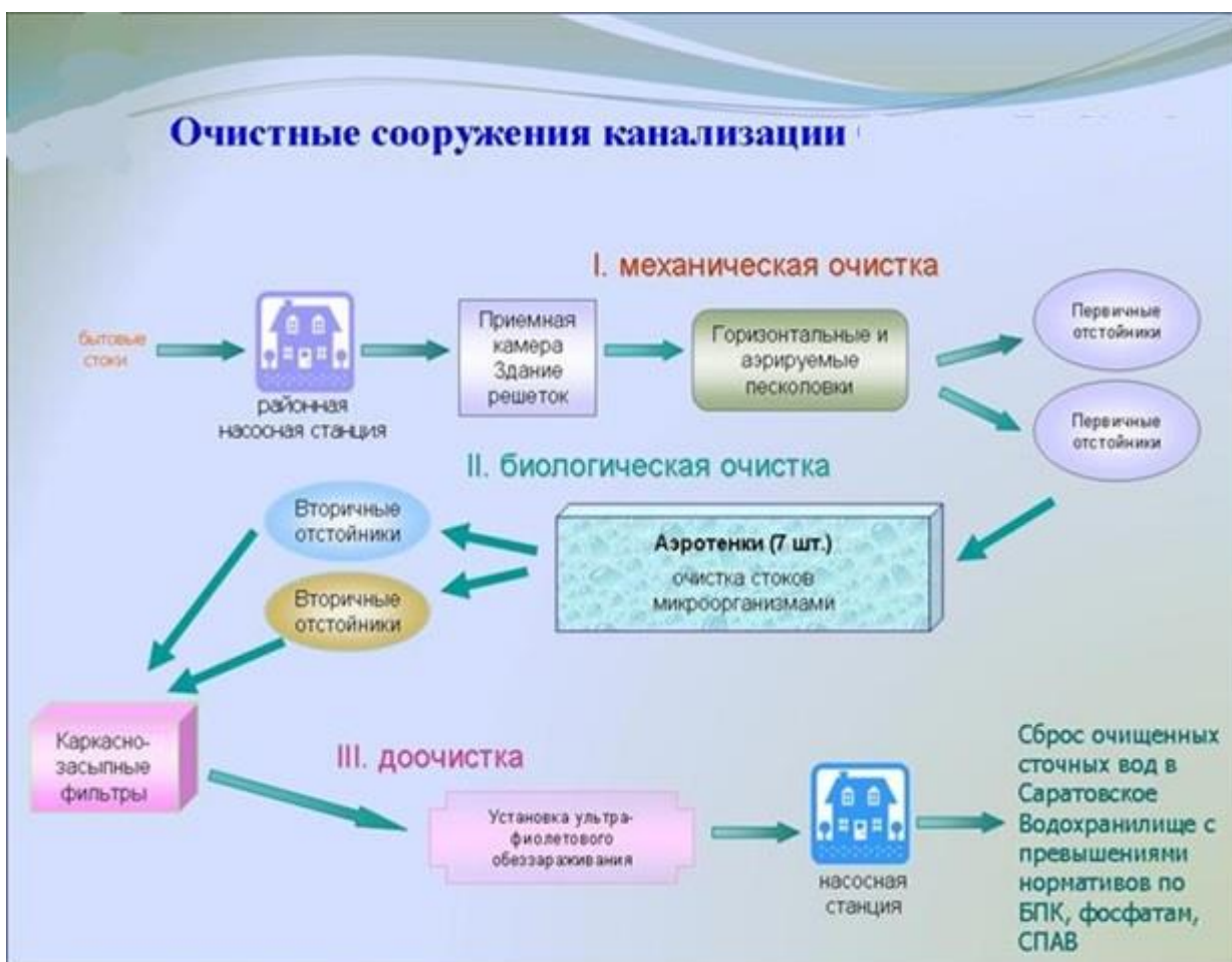
Рисунок 1.1 – Структурная схема очистки сточных вод цеха ОСК
