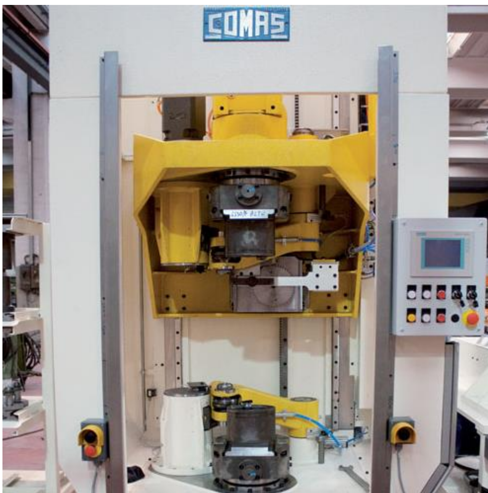
Рисунок 3 – Вертикальная закаточная машина «Comas»
