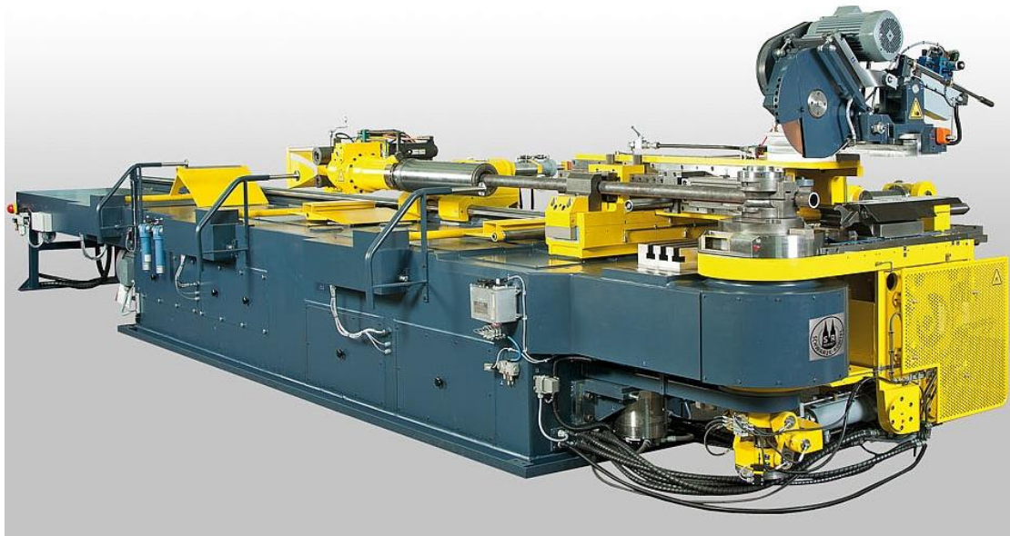
Рисунок 2 – Трубогибочная машина «Schwarze Robitec»
