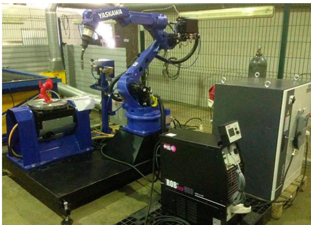
Рисунок 4 – Сварочный манипулятор «Yaskawa»
