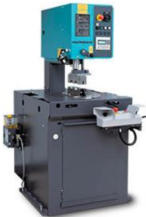
Рисунок 10 – Полуавтоматический станок с дисковой пилой для распила профилей под углом «Kaltenbach KKS 400T»
