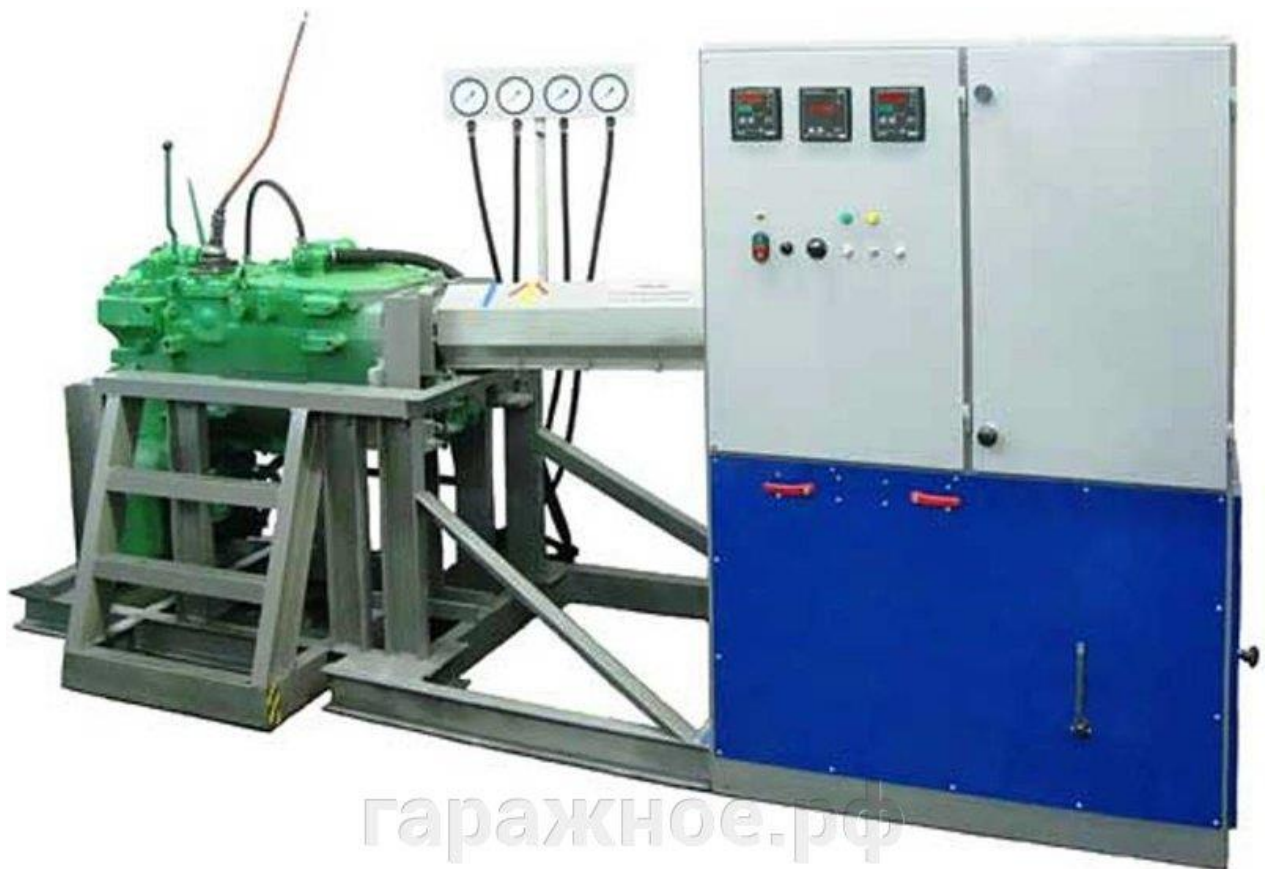
Рисунок 2.5 - Стенд для настройки и обкатки КПП КИ-28291
