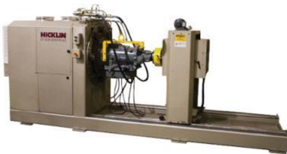
Рисунок 2.3 - Динамометр трансмиссии (Трансмиссионный тестер)
